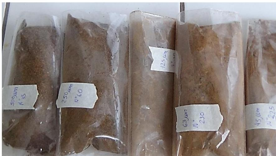
Tamizado por tamaño de partícula de 500  $\mu\text{m}$ , 250  $\mu\text{m}$ , 125  $\mu\text{m}$ , 63  $\mu\text{m}$  y 45  $\mu\text{m}$
