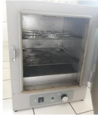
Proceso de impregnación química con  $\text{HNO}_3$  0.10 M - Secado
