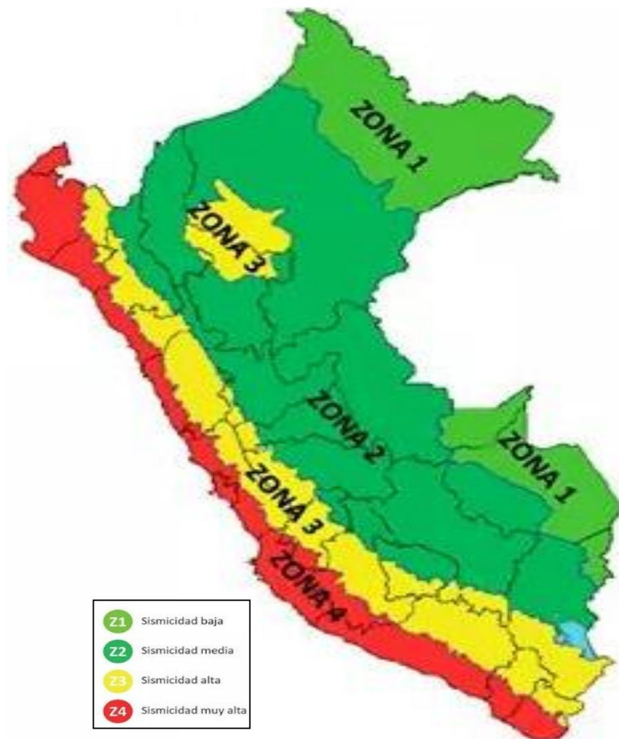
Figura 6. Zonificación Sísmica (Norma E 030)
