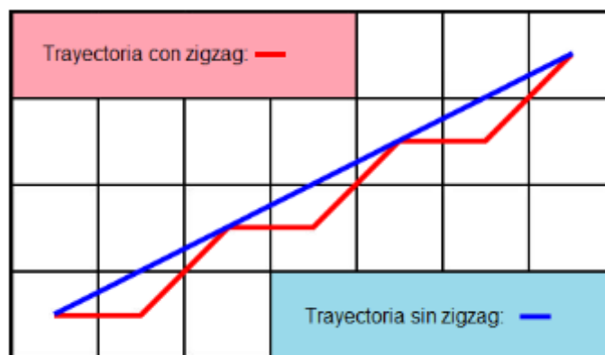
Figura 14. Corrección del zigzagueo de la trayectoria
