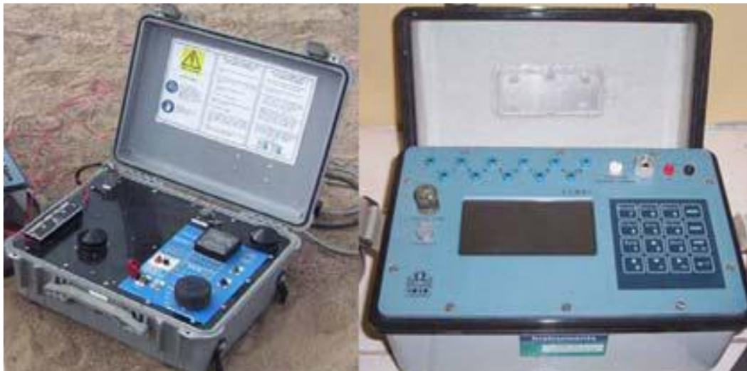
Figura 22. Adquisición de los Datos de Campo con el Receptor Iris ElRec Pro y Transmisor GDD.
