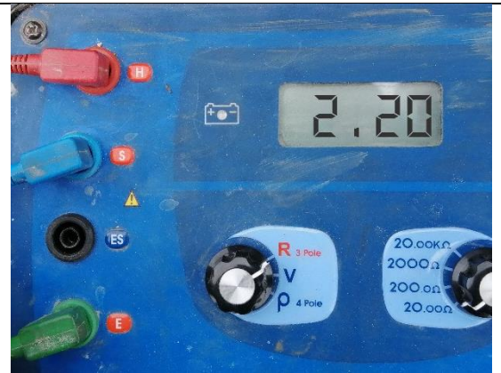
Foto 56.- Medición después de la mejora 2.20 \Omega
