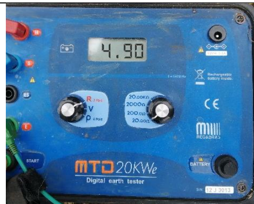
Foto 16.- Medición después de la mejora 4.90 \Omega
