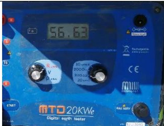
Foto 27.- Medición antes de la mejora 56.63 \Omega
