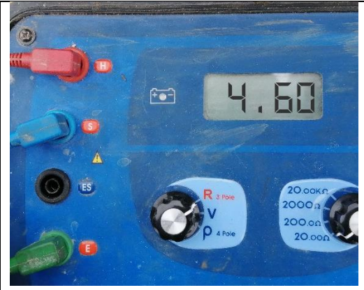
Foto 46.- Medición después de la mejora 4.60 \Omega
