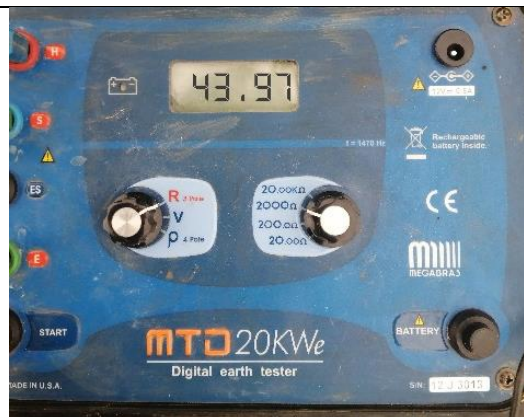
Foto 17.- Medición antes de la mejora 43.97 \Omega
