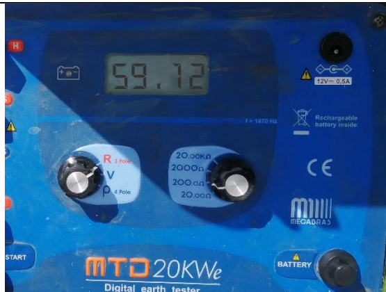
Foto 55.- Medición antes de la mejora 59.12 \Omega
