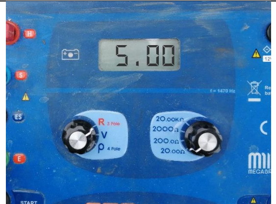
Foto 58.- Medición después de la mejora 5.00 \Omega
