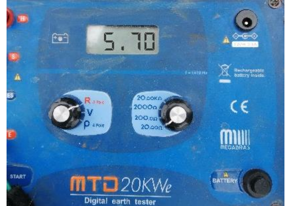
Foto 30.- Medición después de la mejora 5.70 Ω
