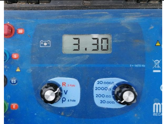
Foto 52.- Medición después de la mejora 3.30 Ω
