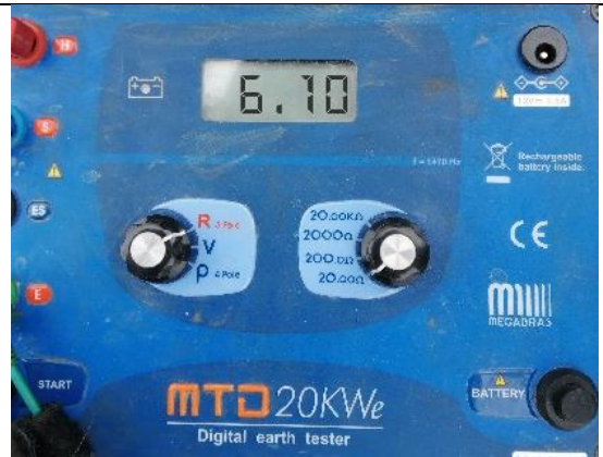
Foto 26.- Medición después de la mejora 6.10 \Omega
