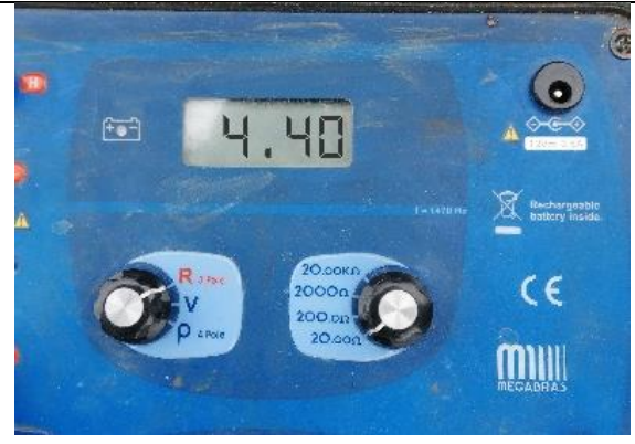
Foto 32.- Medición después de la mejora 4.40 Ω
