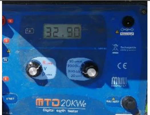
Foto 33.- Medición antes de la mejora 32.90 Ω
