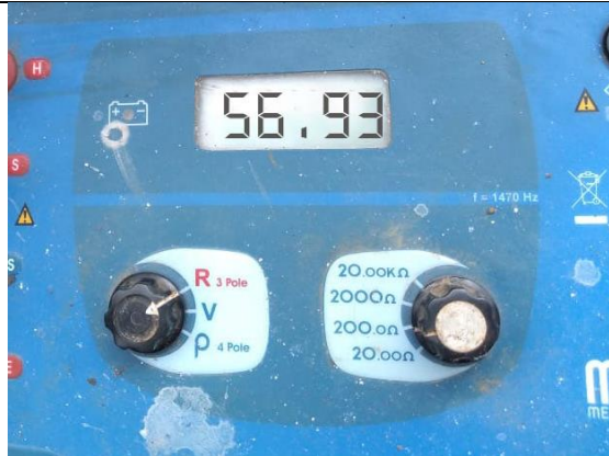
Foto 57.- Medición antes de la mejora 56.93 \Omega
