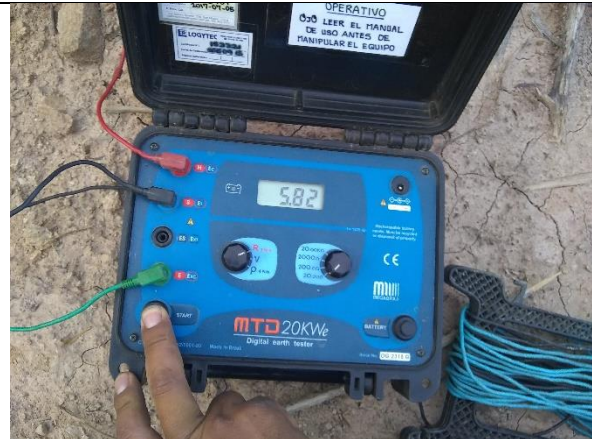
Foto 10.- Medición después de la mejora 5.80 Ω
