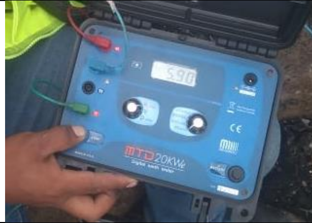
Foto 8.- Medición después de la mejora 5.90 Ω
