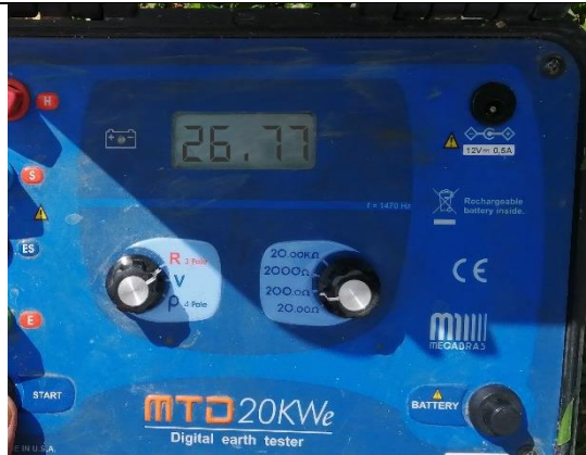
Foto 39.- Medición antes de la mejora 26.77 \Omega
