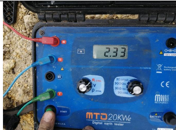
Foto 12.- Medición después de la mejora 2.30 Ω
