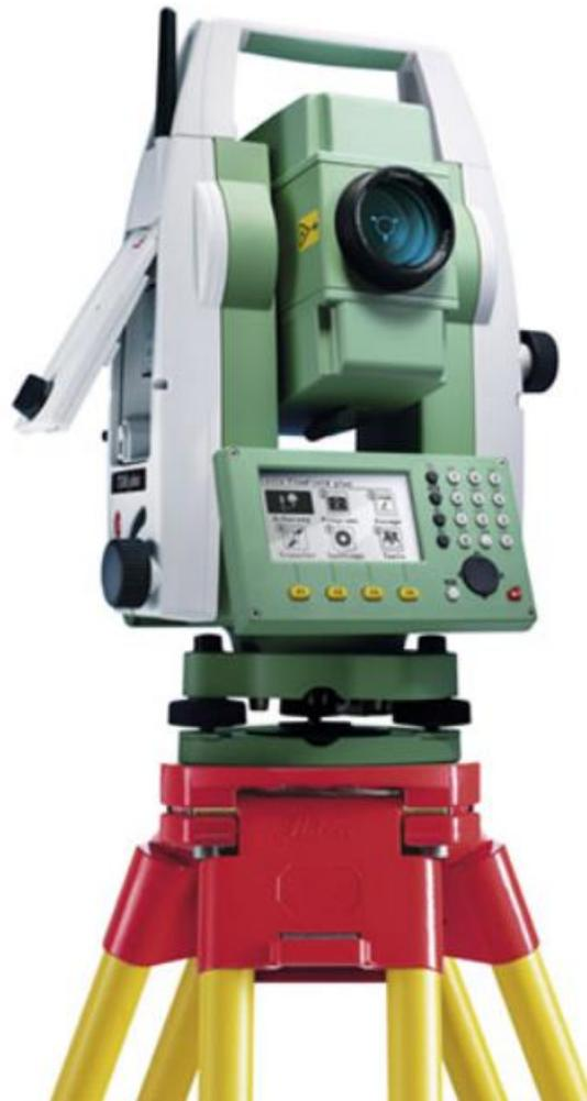
Figura 22. Estación Total Leica TS07 R500 de 5"
