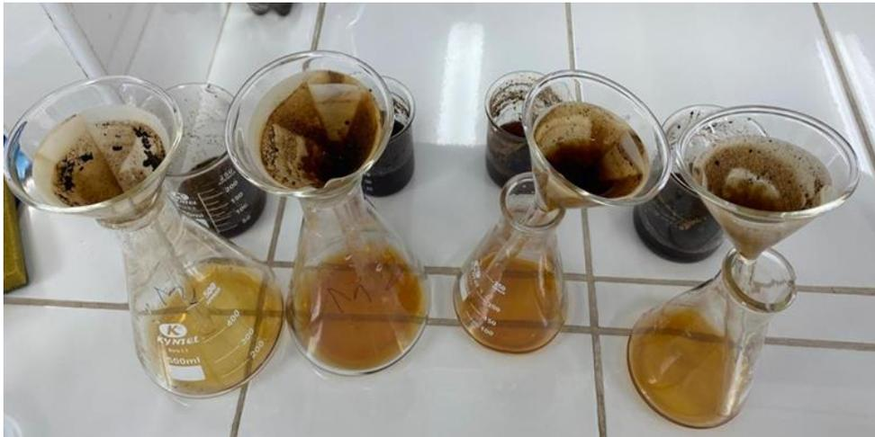
*Figura 7 Pre digestión y filtración de muestras*
