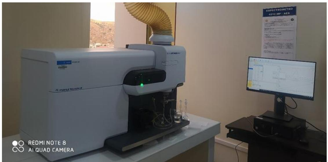
*Figura 10 Espectrómetro 4210 MP – AES*
