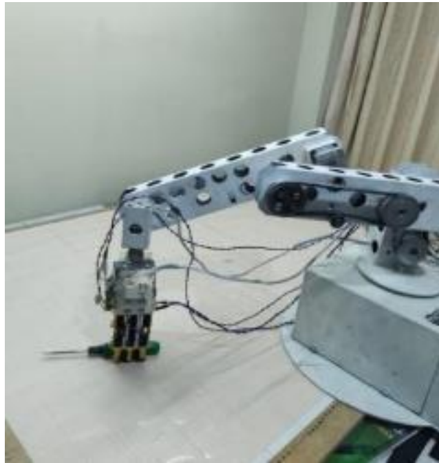
Figura 117: Agarre de objeto con cinemática
