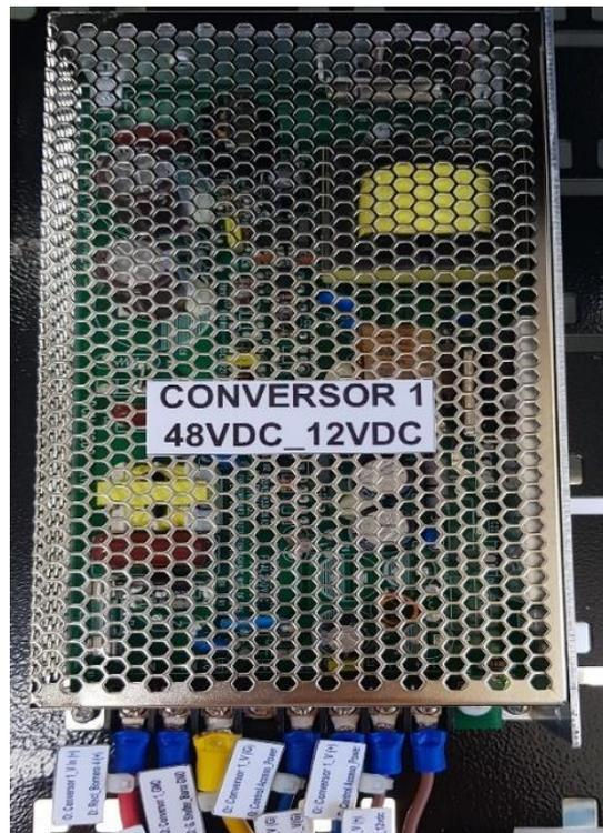
**Figura 19:** Conversor  $-48\text{VDC}$  a  $12\text{VDC}$ .
