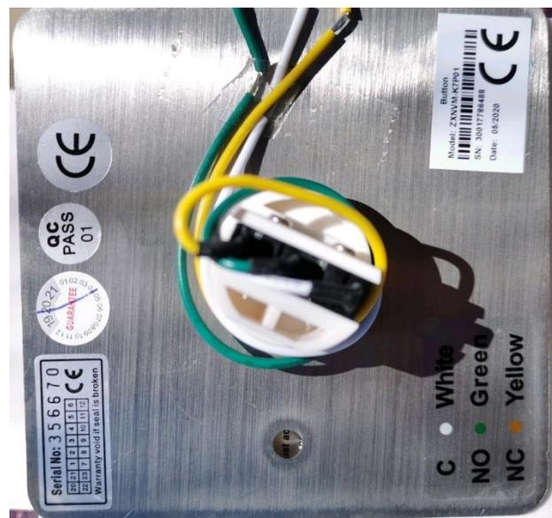
**Figura 46:** Vista Posterior del Botón de Salida, Conexión NO.
