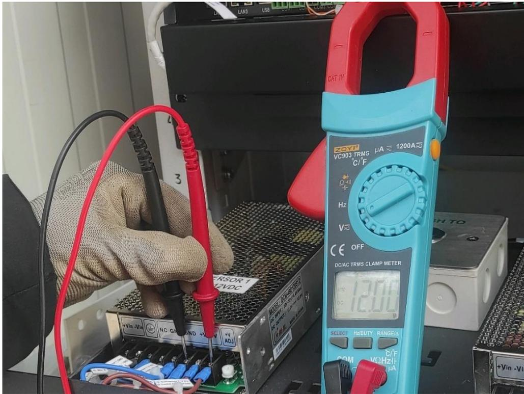
**Figura 62:** Salida de Voltaje del Conversor 12VDC.
