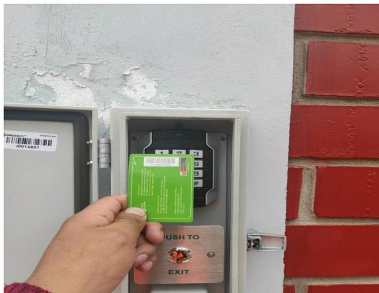
**Figura 71:** Prueba del Lector RFID con la Tarjeta.
