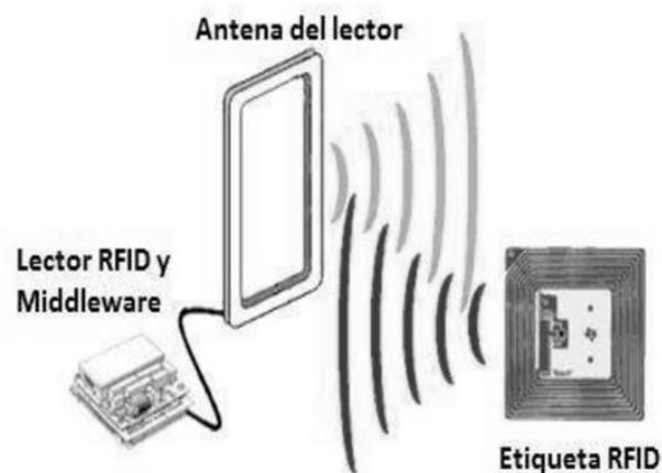
**Figura 2:** Composición de Lector de Tarjeta RFID.
