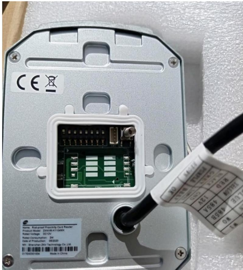
**Figura 38:** Configuración de Pin para el Lector RFID.
