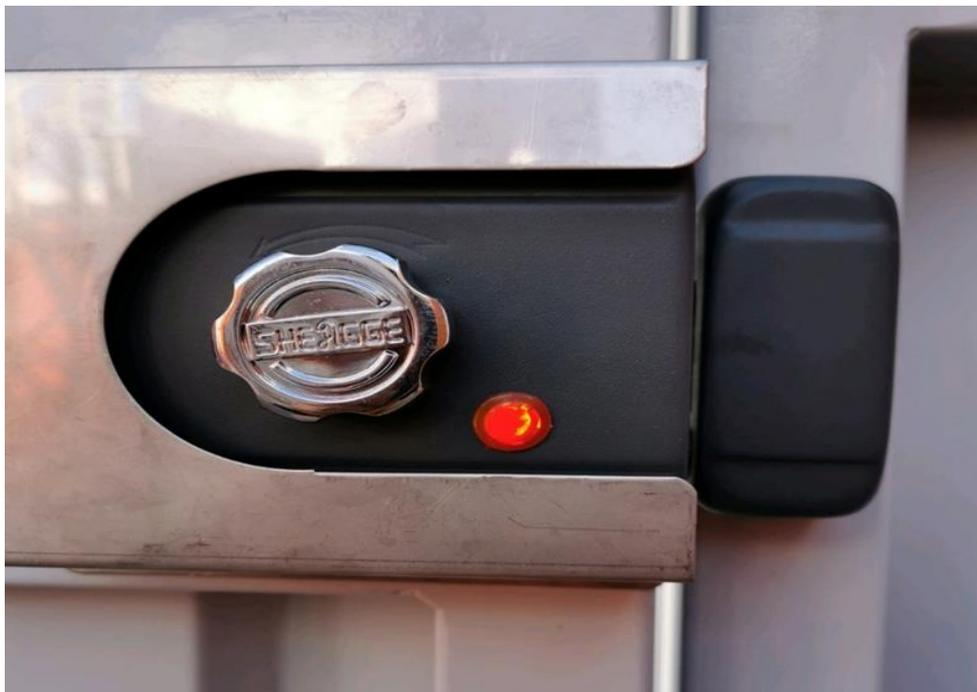
**Figura 69:** Led Indicador del Funcionamiento de la Cerradura Eléctrica.
