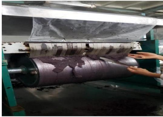
**Figura 7.** Secado de Mashua Negra en el Secador de Rodillos o Secador de Tambor
