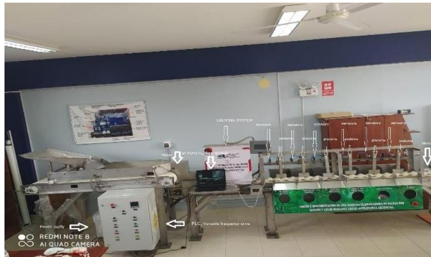
**Figura 18:** Planta clasificadora de patatas
