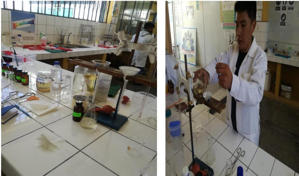
**Figura 22.** Filtrando las muestras de agua después del proceso de agitación magnética
