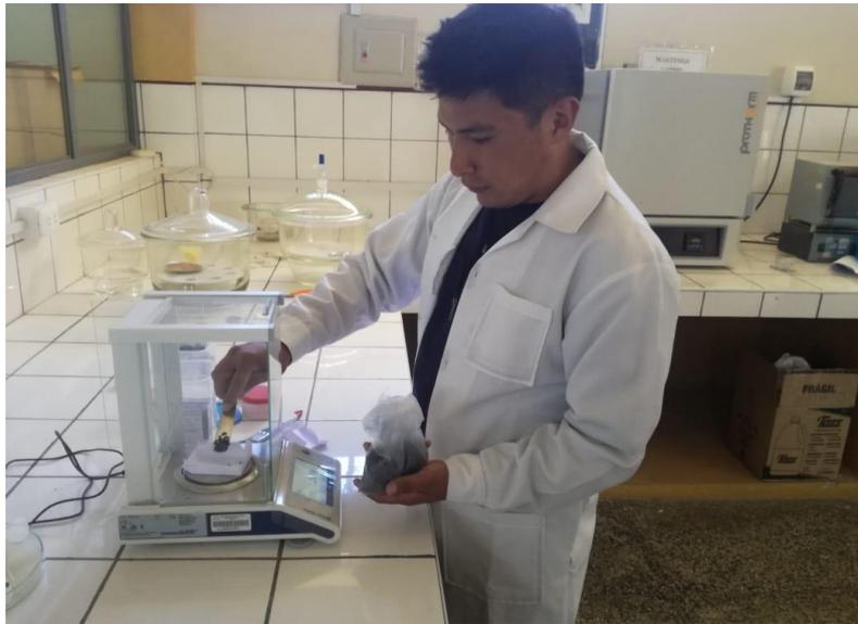
**Figura 16.** Pesando el carbón activado
