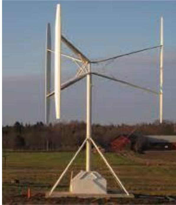
**Figura 9:** Generador Eólico – VAWT.
