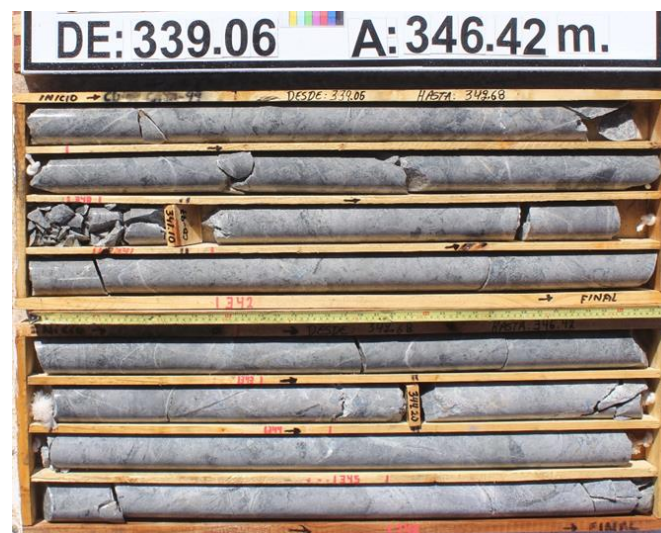
Figura 19: Testigos extraídos, puestas en caja
