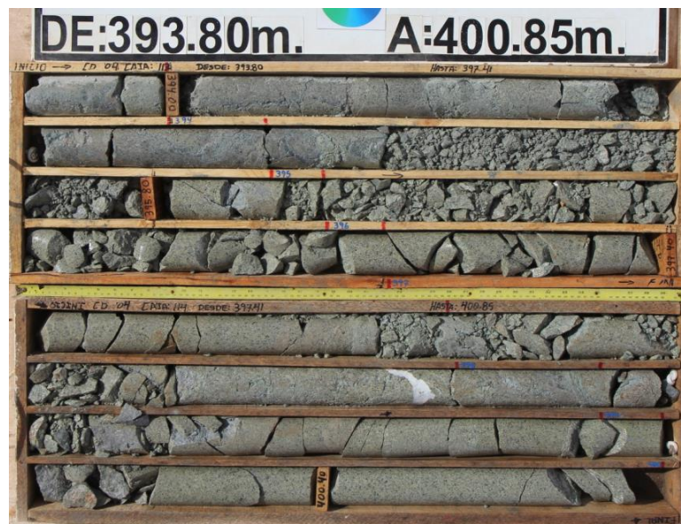
Figura 39: Testigos de perforación; Zonas de falla, tramos agilizados y de alteración propílica.
