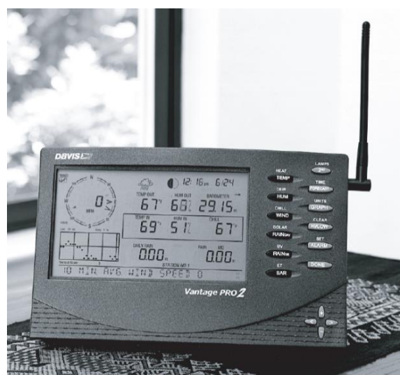
Figura 26. Consola donde se almacenan los datos reportados por la estación
