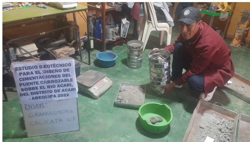
Fotografía 82 Ensayo de granulometría.
