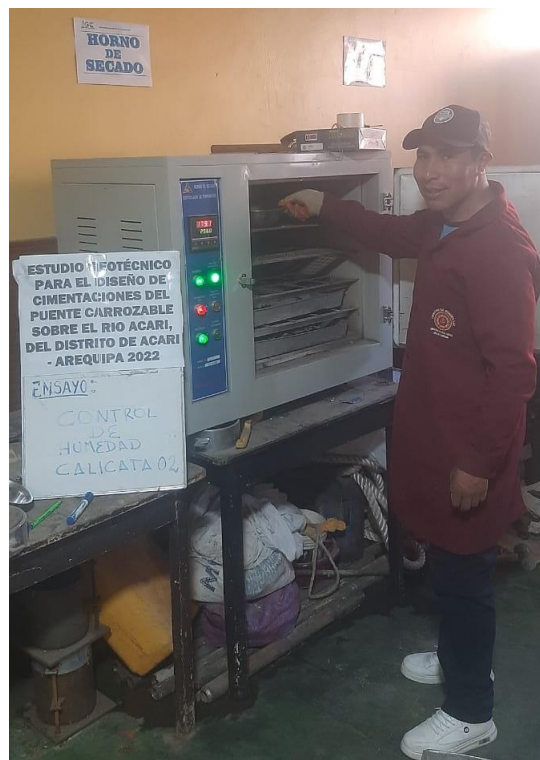
Fotografía 6 Ensayo de contenido de humedad
