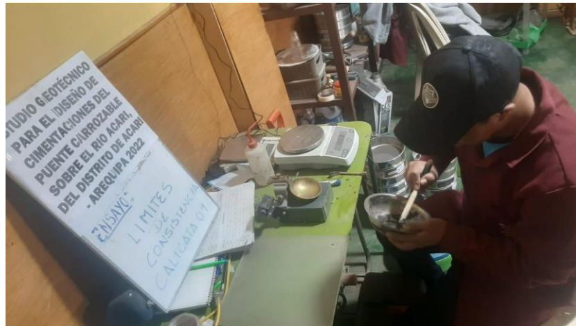
Fotografía 7 Ensayo de límites de consistencia
