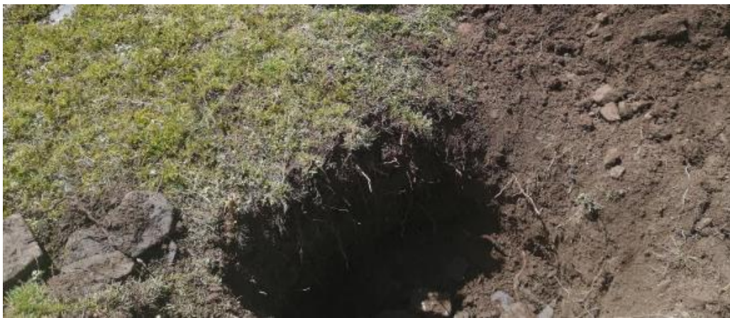
Figura N° 23 Deposito coluvies, calicata en el eje de la presa
