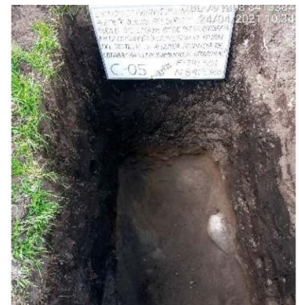
Figura N° 47 Registro estratigráfico de la calicata C-05 de la presa
