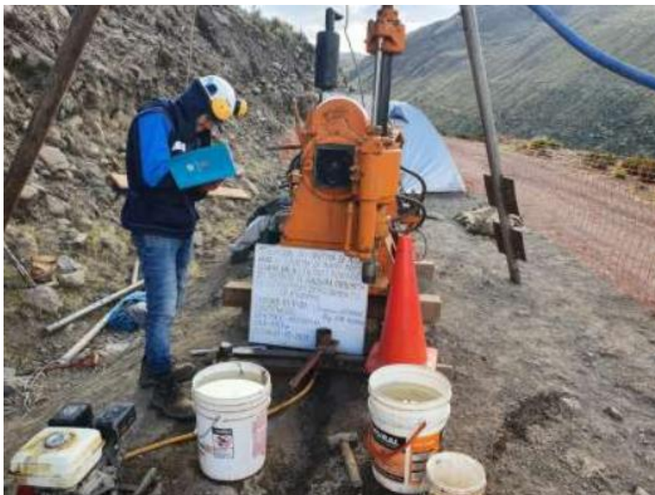
Figura N° 16 Vista del ensayo de Lefranc
