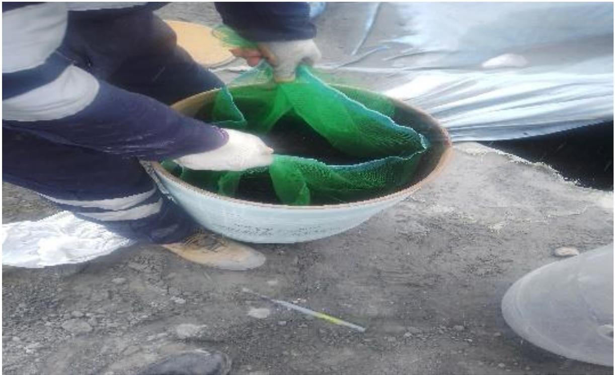
*Figura 37. Toma de muestra de carbón activado.*
