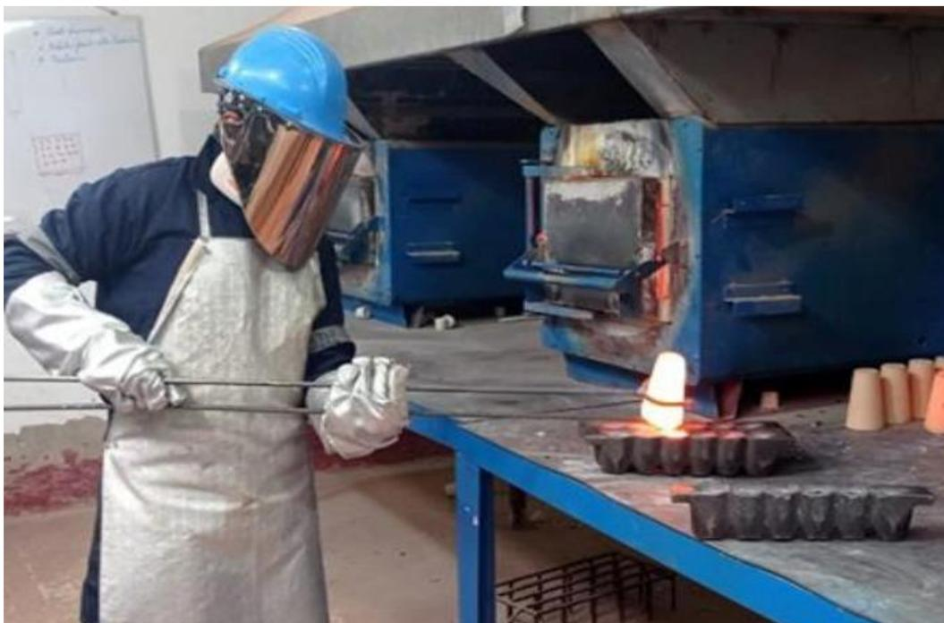
*Figura 34. Realizando la colada para análisis por ensayo al fuego.*
