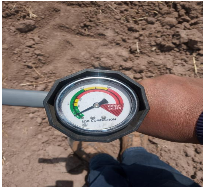
Figura 30. Imagen de un penetrometro actual analógico.
