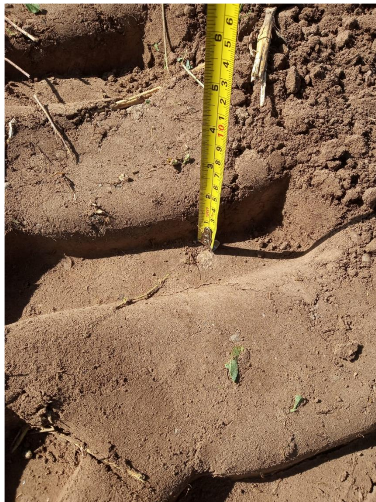
Figura 38. Lectura de la profundidad de huella del tractor de 98 hp
