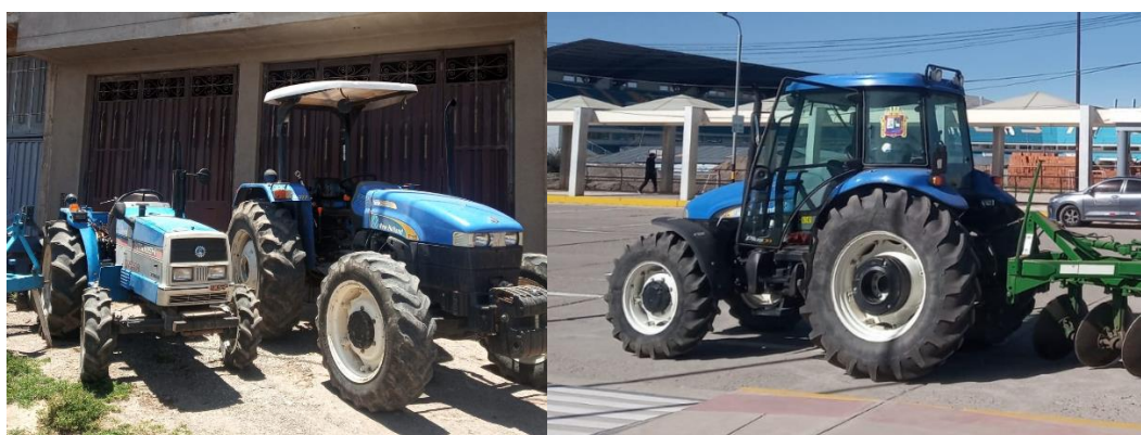
Figura 33. Tractores utilizados de Izq. A Der Mitsubishi de 25 hp, New Holland TT65 de 65hp y New Holland TD 95D de 98hp
