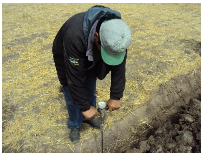
Figura 3. Forma de medir la resistencia a la penetración en libras por pulgada cuadrada (psi) con penetrometro
