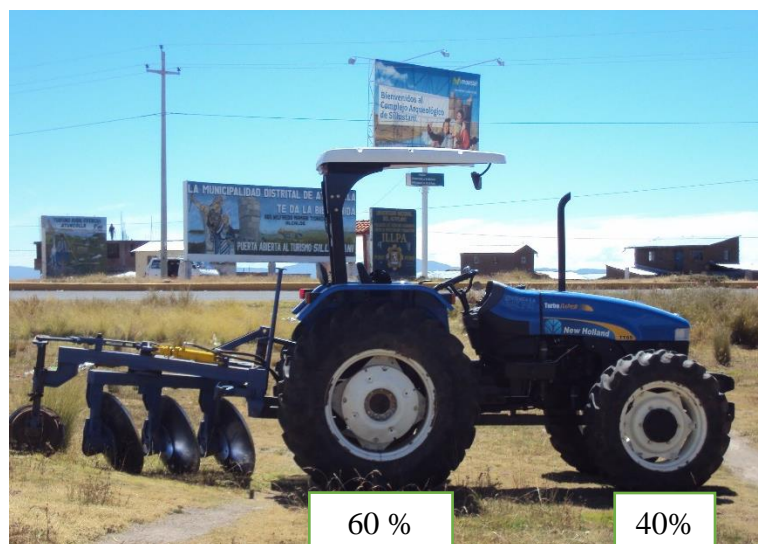
Figura 34. Reparto de pesos estáticos en tractores de cuatro ruedas motrices desiguales
