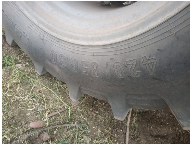
Figura 37. Neumático posterior tractor de 65hp de 420mm de ancho por 85% de alto y radial de 30 pulgadas de diámetro interior
