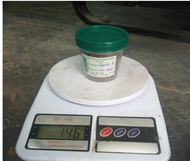
Figura 5. Muestra de suelo envasado para análisis microbiológico en laboratorio
