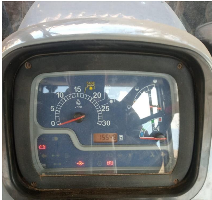
Figura 35. Horotacometro de tractor donde se regula según las rpm la velocidad de avance.
