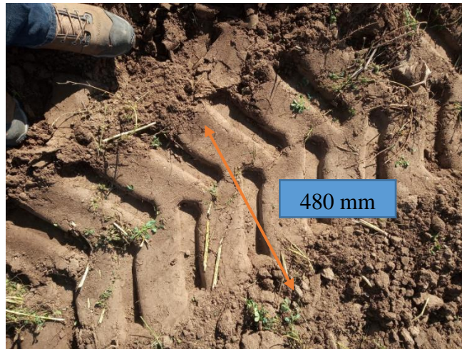
Figura 39. Imagen del ancho efectivo del neumático radial tractor de 98 hp
