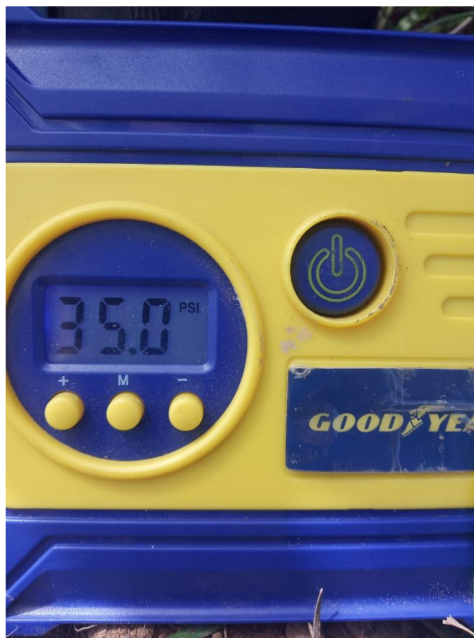
Figura 36. Instrumento de medición digital de presión de neumáticos en libras por pulgada cuadrada (psi)
