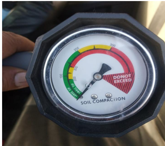
Figura 4. Escalas de compactación del suelo en el penetrometro Spectrum Technologies
