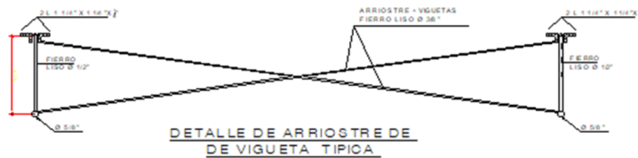
Figura 42. Detalles de arriostre de vigueta típica
