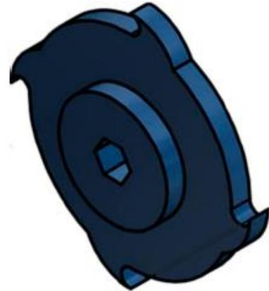
De acuerdo a la geometría de la cuchilla considerando un espesor de 24.5 mm tenemos el peso aproximado de la cuchilla de 8.39.kg.
