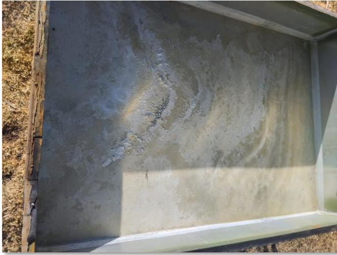
Se puede observar que después de su tratamiento mediante el equipo de destilador solar quedan residuos de sales y otros minerales que quedan dentro de la bandeja de aluminio donde se almacena el agua subterránea salada, para lo cual se debe de realizar una limpieza para no acumular dichos residuos.
