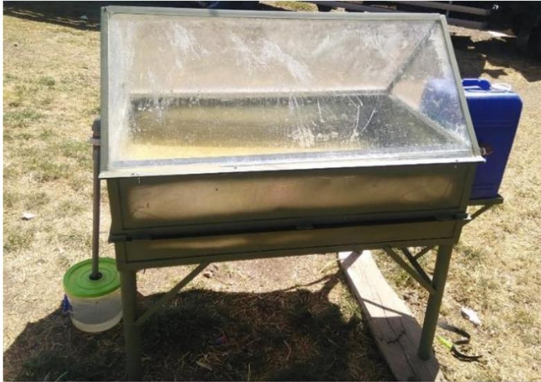
Se puede observar el prototipo destilador solar terminado para iniciar con el procedimiento de destilación natural mediante la energía solar para la obtención de agua procesada.
