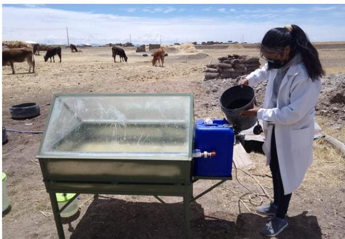
Luego de terminar de ingresar el agua subterránea salada a la bandeja posteriormente se tiene que cerrar la llave de paso para que el destilador solar este herméticamente cerrado, para que no pueda existir fugas de vapor de agua ni de aire. Exponer al sol de forma continua durante todo el día para completar el proceso de destilación en 24 horas.
