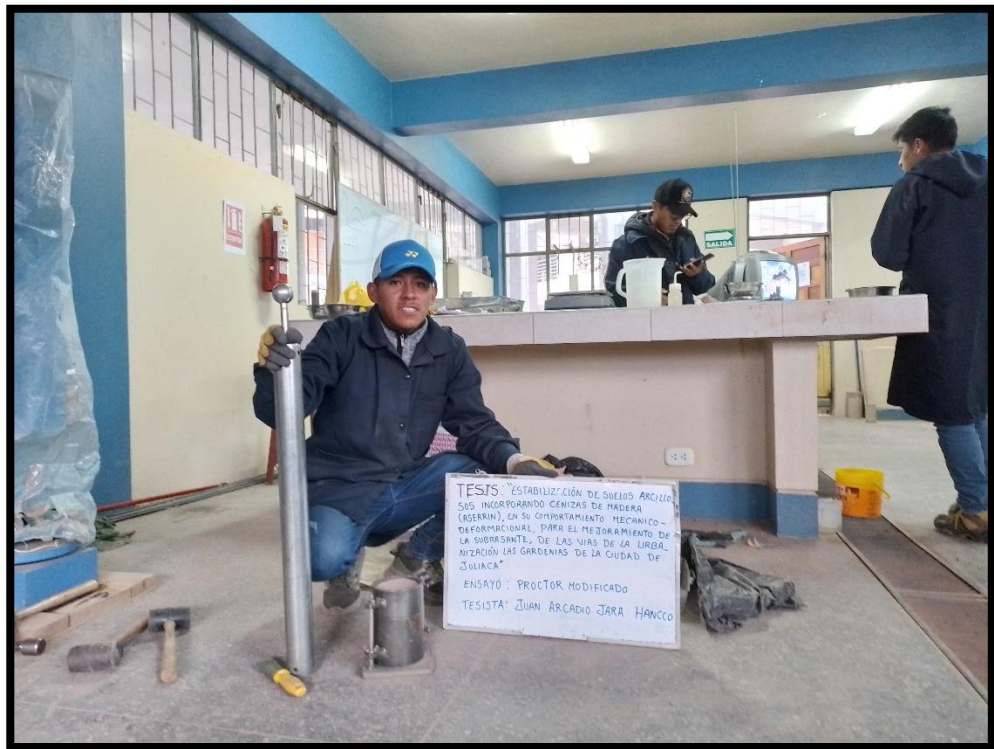
Fotografía 7: Ensayo de compactación proctor modificado
