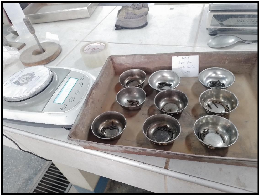
Fotografía 5: Ensayo de límites de consistencia (LL y LP).
