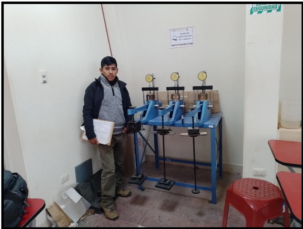
Fotografía 16: Ensayo de consolidación lectura de deformaciones.
