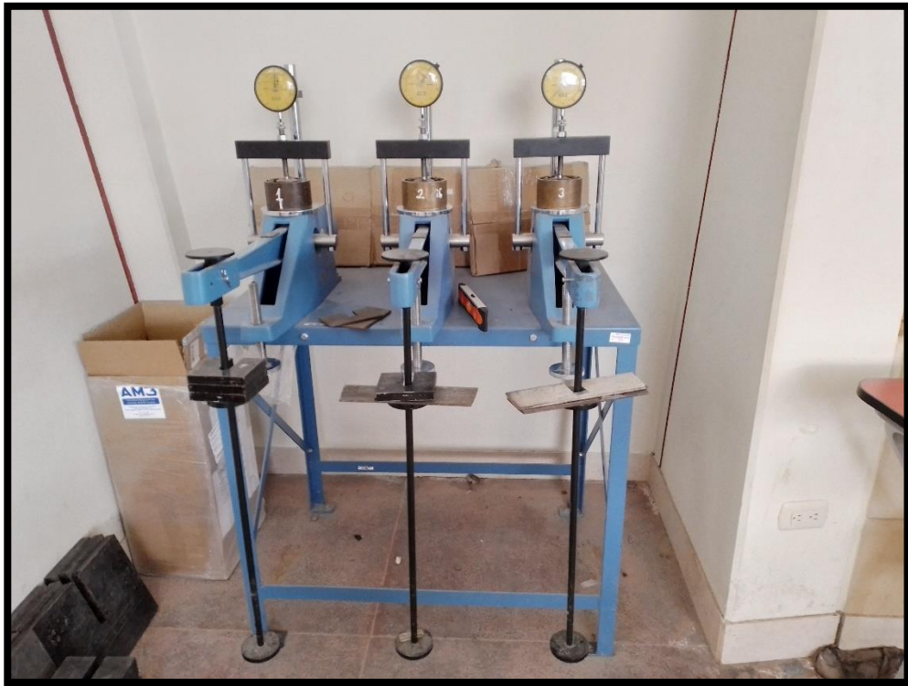
Fotografía 15: Ensayo de consolidación – Carga.
