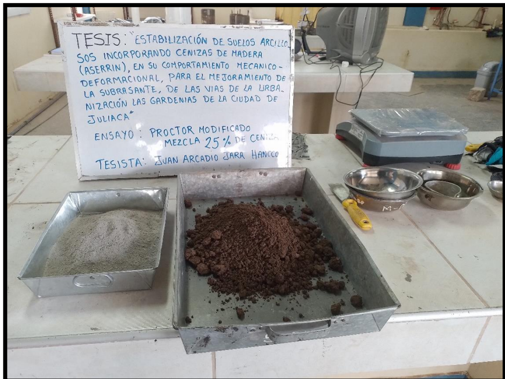
Fotografía 8: Ensayo de Proctor modificado con mezclas de ceniza
