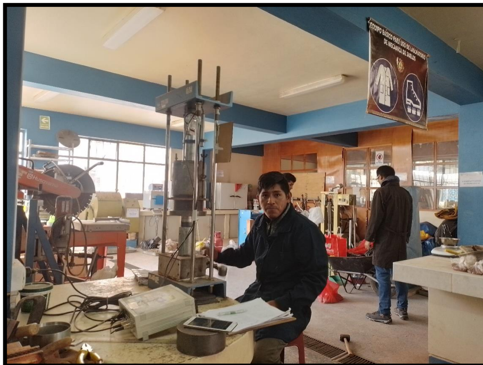
Fotografía 12: Ensayo de CBR resistencia al esfuerzo.
