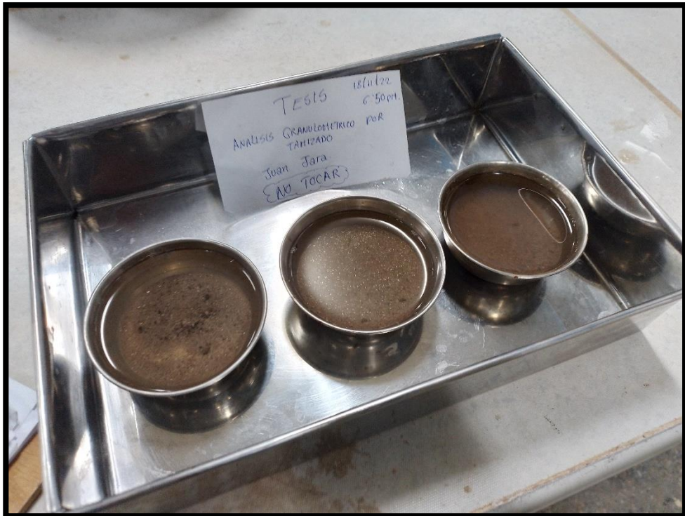
Fotografía 4: Análisis granulométrico por lavado para suelos finos.
