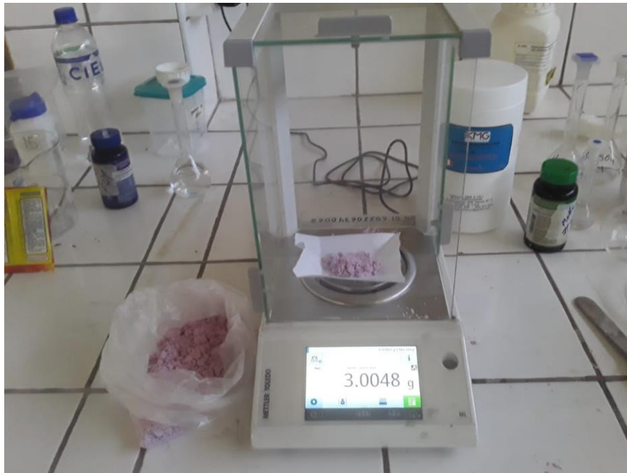
Foto 5: Pesado de producto polvo obtenido para determinación de la humedad
