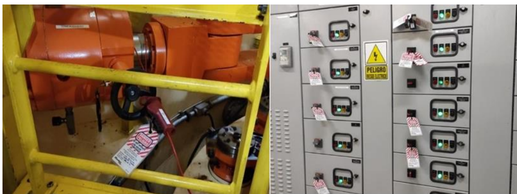
Figura 10. Bloqueo etiquetado de sistemas regulador de velocidad, s. enfriamiento, sello del eje.
