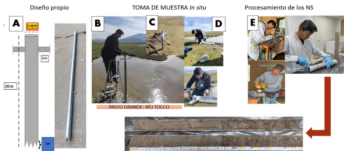
Figura 10. Toma de muestra de los núcleos de sedimentos. A diseño propio de saca testigo. B adentramiento del núcleo golpeando con un bloque sólido. C núcleo de sedimento introducido al máximo para extracción. D Procesamiento de conservación in situ . E Cortes de los núcleos para conservar a -20^{\circ}\text{C} y procesamiento en el laboratorio.
