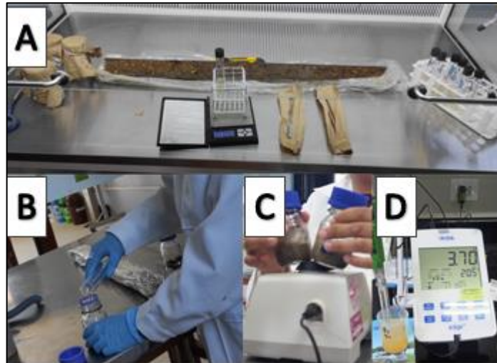
Figura 12. Procedimiento de medición de pH de los niveles de sedimentos. A, sub muestreo de los niveles de sedimento; B, agregación de agua destilada autoclavada; C, homogenización de sedimento con agua utilizando Vortex; D, medición del pH en el equipo Hanna Edge.
