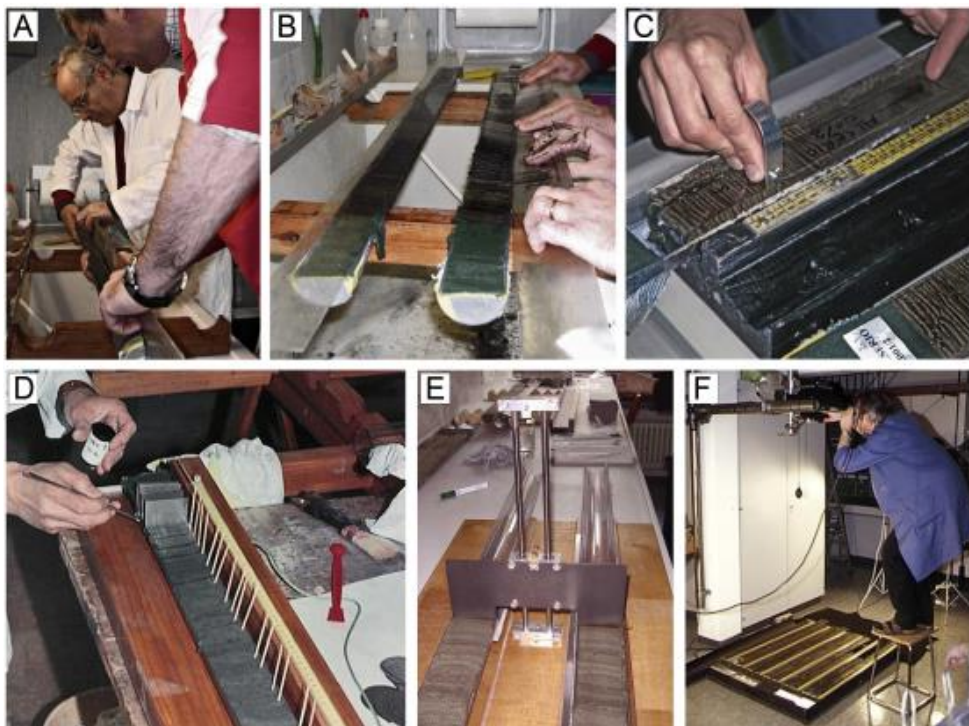
Figura 3. Corte de núcleos y corte longitudinal del núcleo de sedimento mediante láminas metálicas. A-B, seccionamiento de núcleos y corte longitudinal del núcleo de sedimento mediante láminas metálicas; C-D, sub muestreo y diferenciación de los sedimentos; E, dispositivo Klempt para el seccionamiento de NS; F, conservación de los núcleos de sedimentos (Somerfield & Warwick, 2013).
