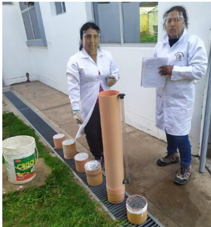
Fotografía 08: prueba de permeabilidad del concreto
