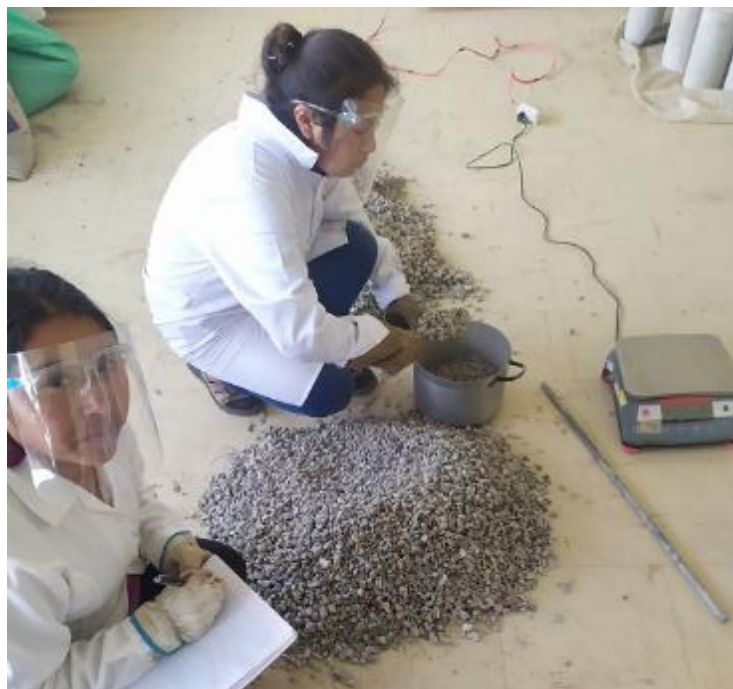
Fotografía 04: Peso unitario del agregado reciclado.
