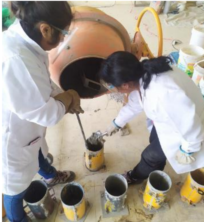
Fotografía 07: Elaboración del concreto permeable.
