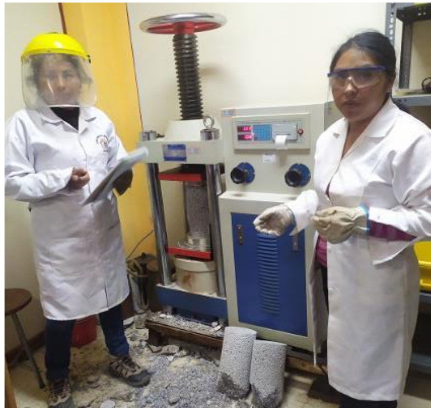
Fotografía 10: Prueba de resistencia a la compresión del concreto permeable
