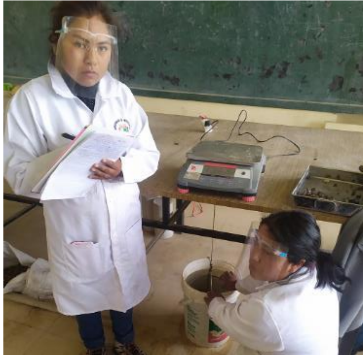
Fotografía 05: Peso específico del Agregado grueso reciclado.
