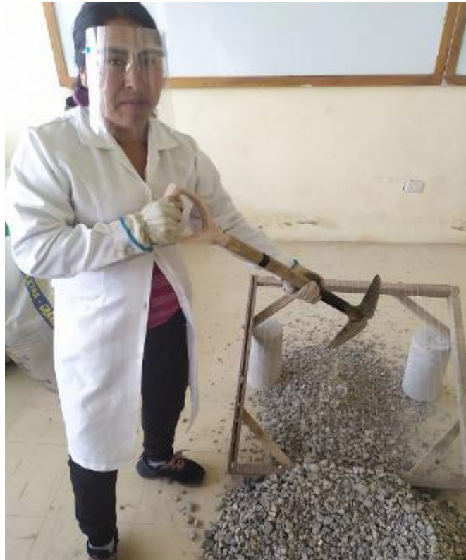
Fotografía 02: Tamizado del Agregado reciclado por la malla 1”.
