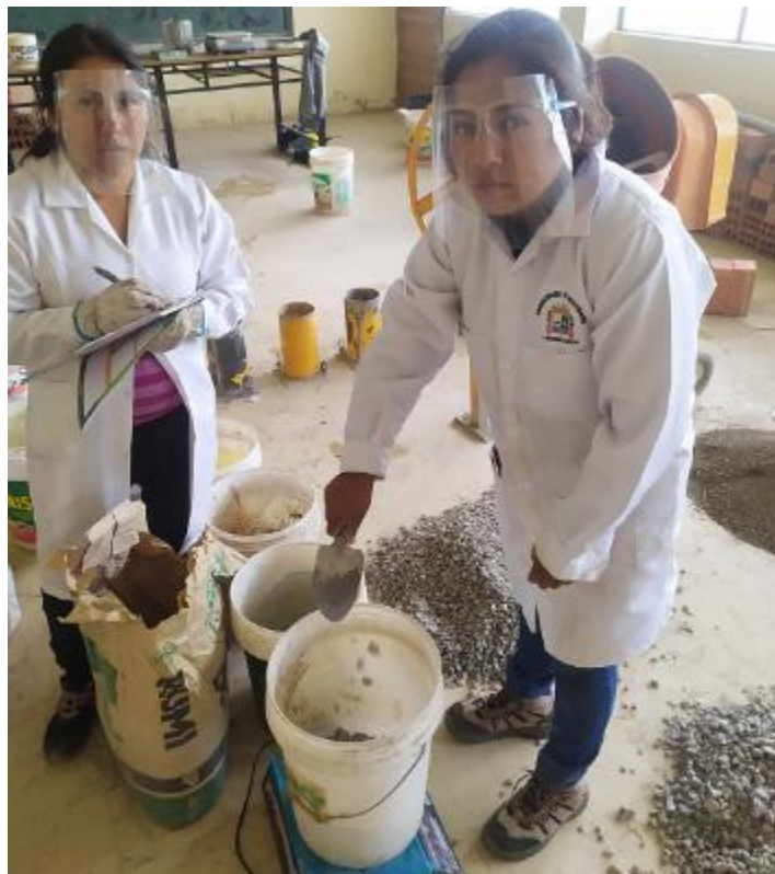
Fotografía 05: Peso específico del Agregado grueso reciclado.
