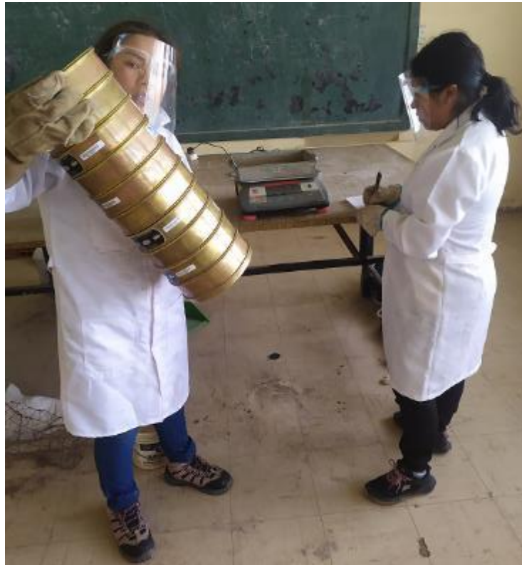
Fotografía 03: Análisis Granulométrico del Agregado.
