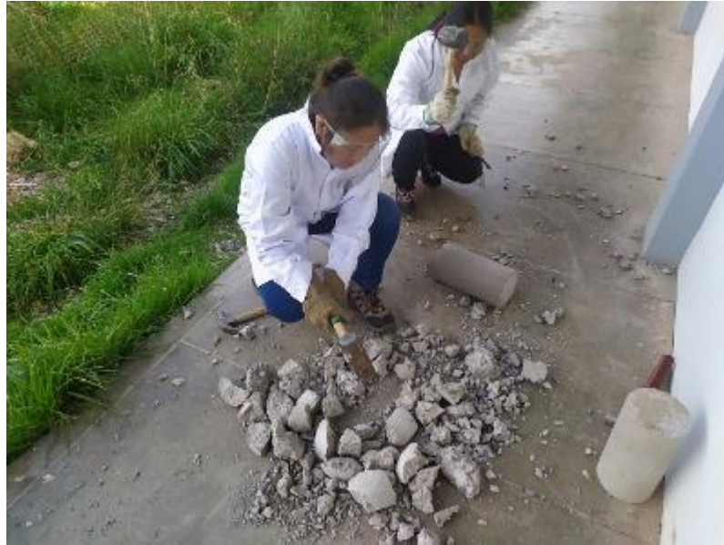
Fotografía 01: Trituración preliminar de especímenes de concreto.
