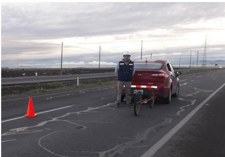
Nota: Se muestra el equipo basado en el sensor de distancia vl5310x en la parte posterior del vehículo el cual a una velocidad de 18 km/hora, procederá a tomar los datos.
