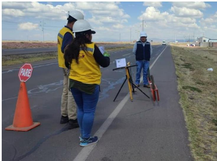
Nota: Equipo con sensor vl5310x previo al inicio de calibración.
