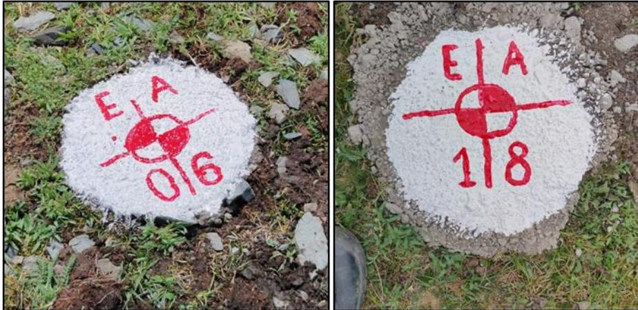
Nota. Se observa los puntos de control para la poligonación.
