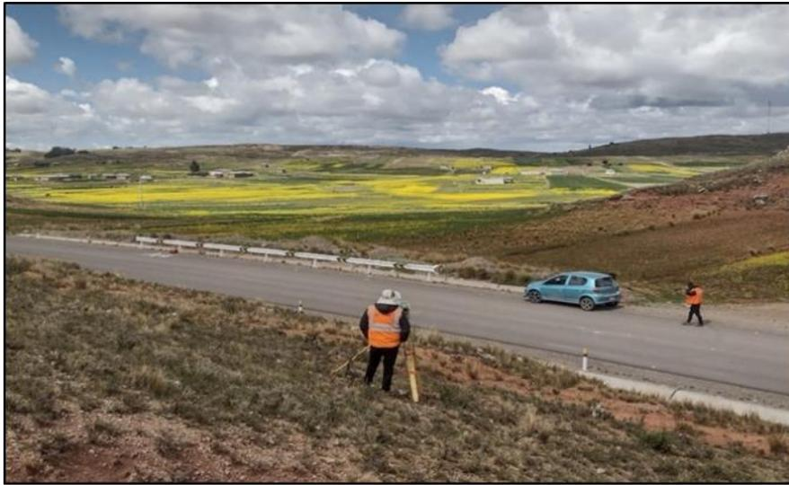
Nota: realización de las lecturas para realizar la poligonal y posterior compensación para realizar el levantamiento con Drone.
