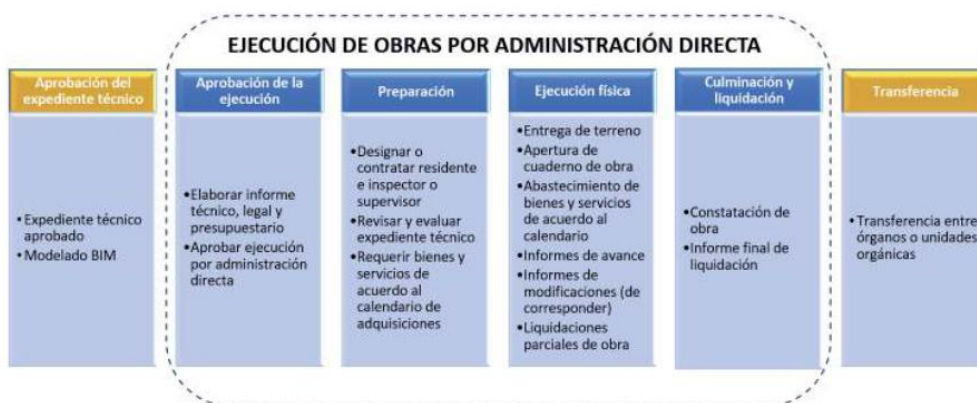
Figura 1 Proceso de ejecución de obras por administración directa
