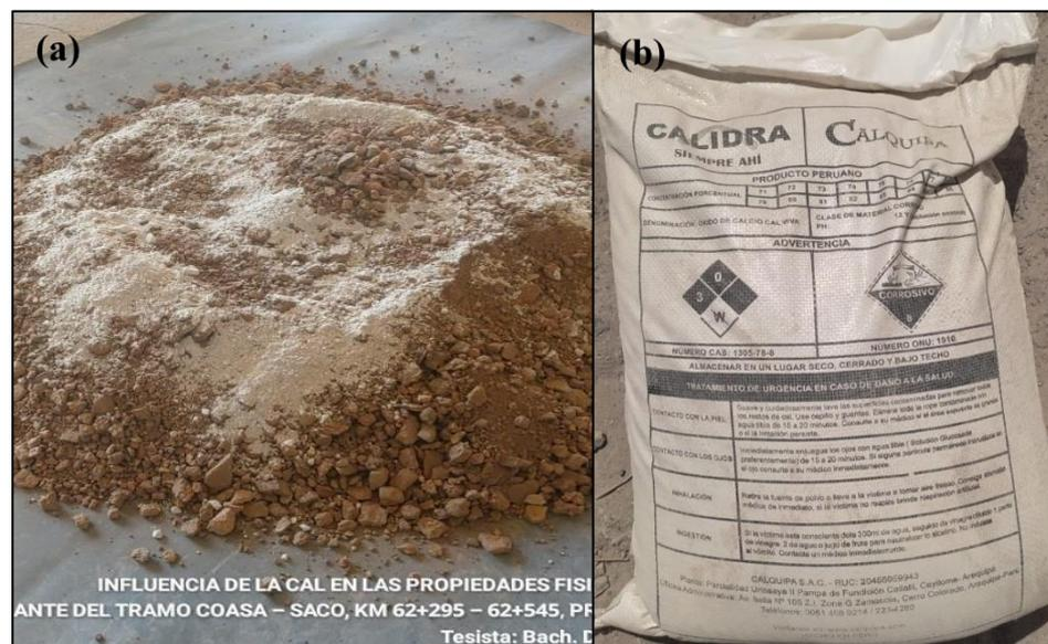
Nota: Figura 21.a, Adición de cal viva al suelo de subrasante. Figura 21.b, Cal viva usada para los ensayos de estabilización.
