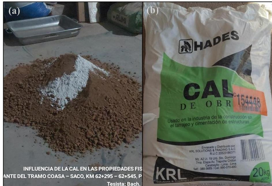
Nota: Figura 20.a, Adición de cal hidratada al suelo de subrasante. Figura 20.b, Cal hidratada usada para los ensayos de estabilización.
