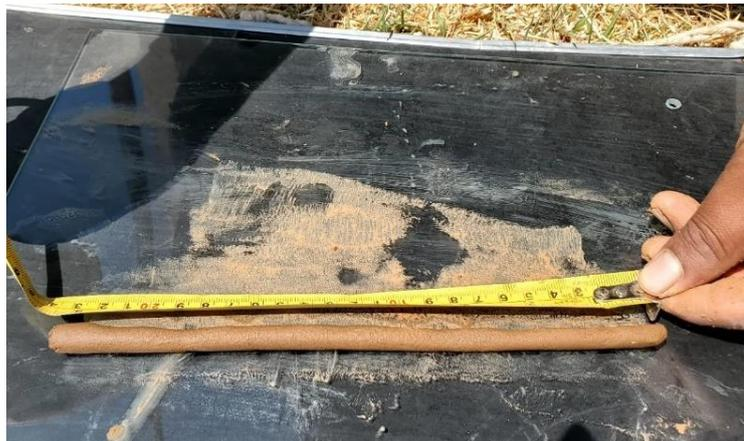
Nota: En la imagen se muestra la formación de cilindros
