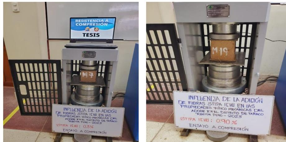
Nota: Colocación de la muestra en el equipo.
