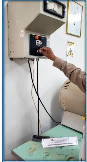
Nota: Se procede a colocar las muestras en la mufla a una temperatura de  $650^{\circ}\text{C}$
