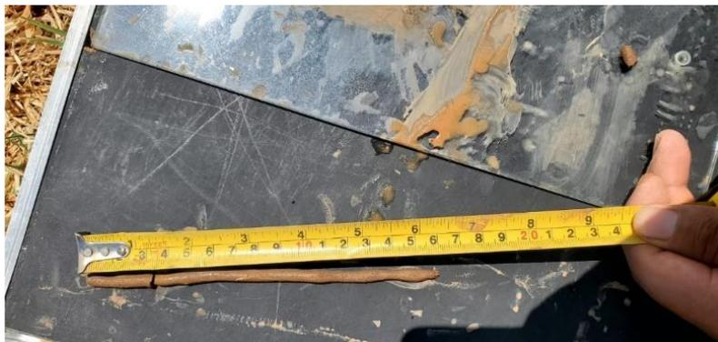
Nota: En la imagen se muestra la medición realizada para determinar el contenido de arcilla.
