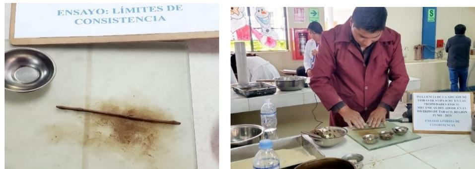
Nota: se visualiza la realización del ensayo para determinar el Límite Plástico.
