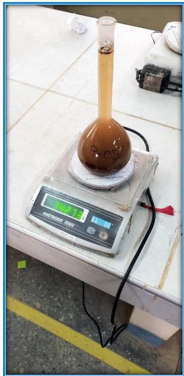
Nota: Las imágenes presentadas corresponden al ensayo de gravedad específica realizado en el “laboratorio de Mecánica de suelos de la EPIC”.
