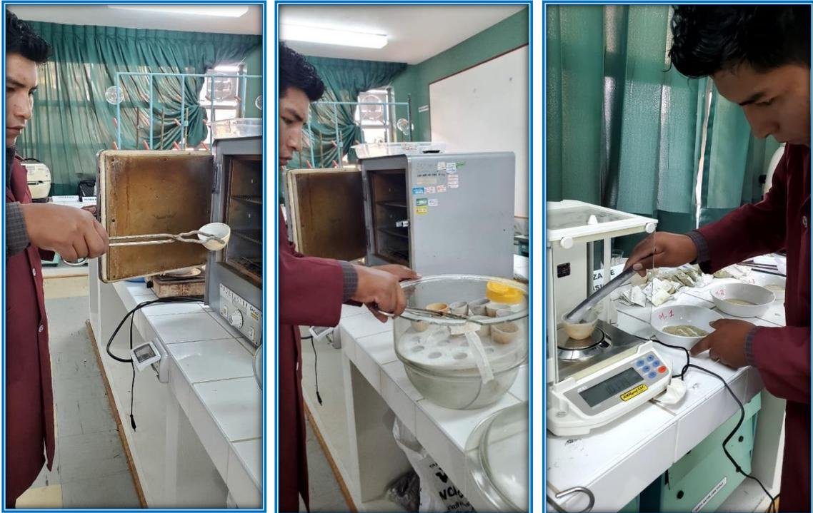
Nota: Las cápsulas de porcelana se dejó secar en la estufa, posteriormente se retira las cápsulas de la estufa y se deja enfriar en el desecador de campana de vidrio, durante un aproximado de 30 min, y finalmente se registra el peso de las cápsulas.
