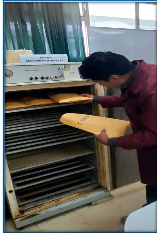
Nota: Proceso de secado: Se somete la muestra a un proceso de secado en la estufa (durante 24 horas).
