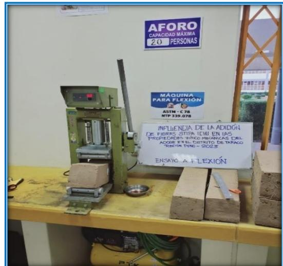
Nota: Montaje y aplicación de la carga y registro de datos.
