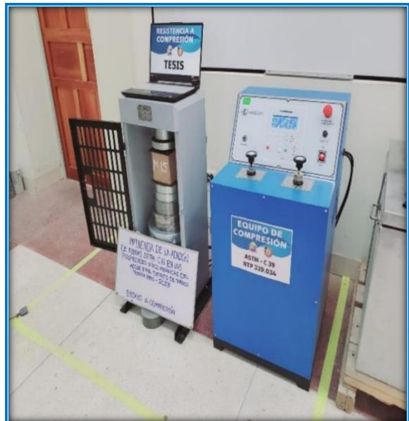
Nota: Montaje de la muestra al equipo de compresión
