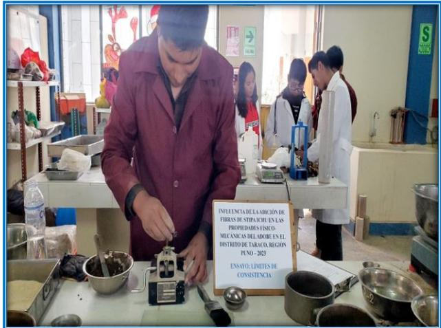
Nota: se visualiza los materiales utilizados y procedimiento del ensayo de Límite Líquido
