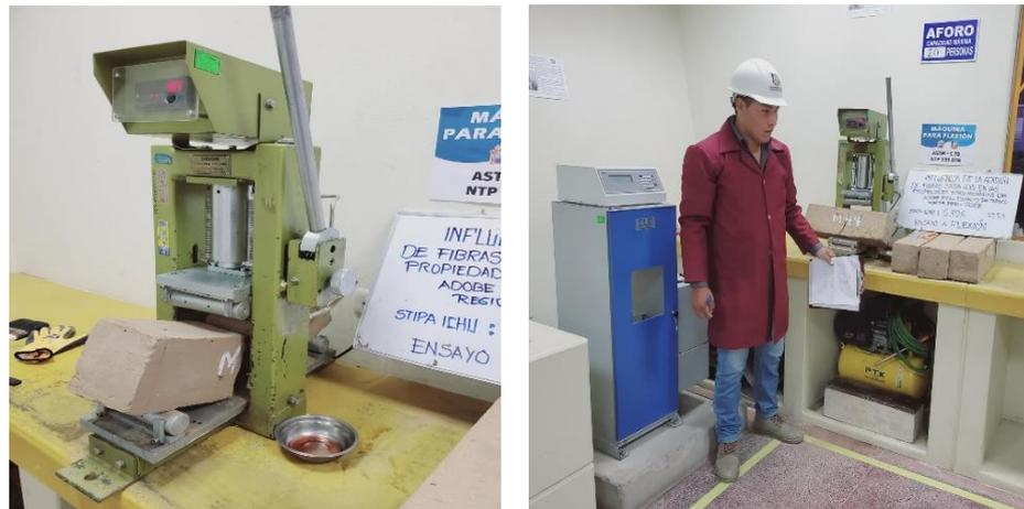
Nota: Aplicación de la carga en el equipo de resistencia a flexión.
