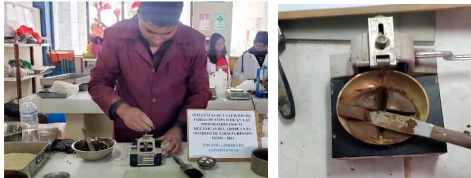
Nota: Ensayo realizado para determinar el Límite Líquido
