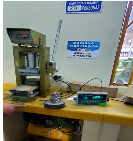
Nota: Se utilizó un equipo de flexión estándar, configurado y con trazabilidad según las especificaciones.
