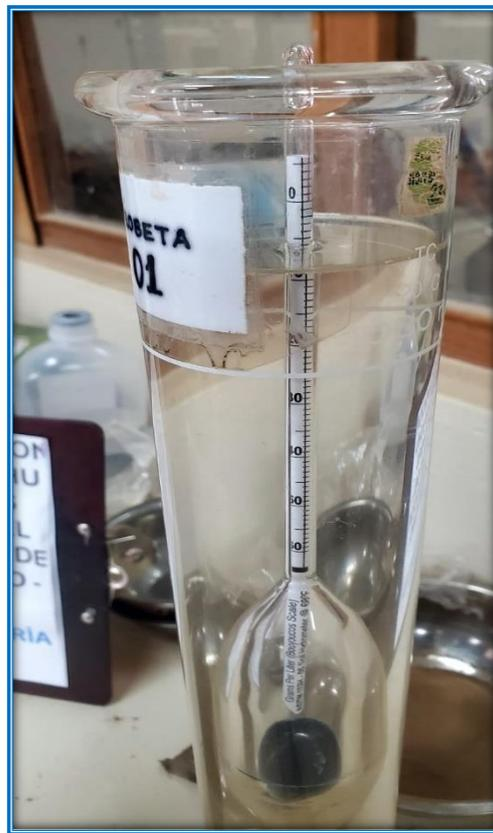
Nota: Las imágenes presentadas corresponden al ensayo de granulometría por hidrómetro realizado en el “laboratorio de Mecánica de suelos de la EPIC”.
