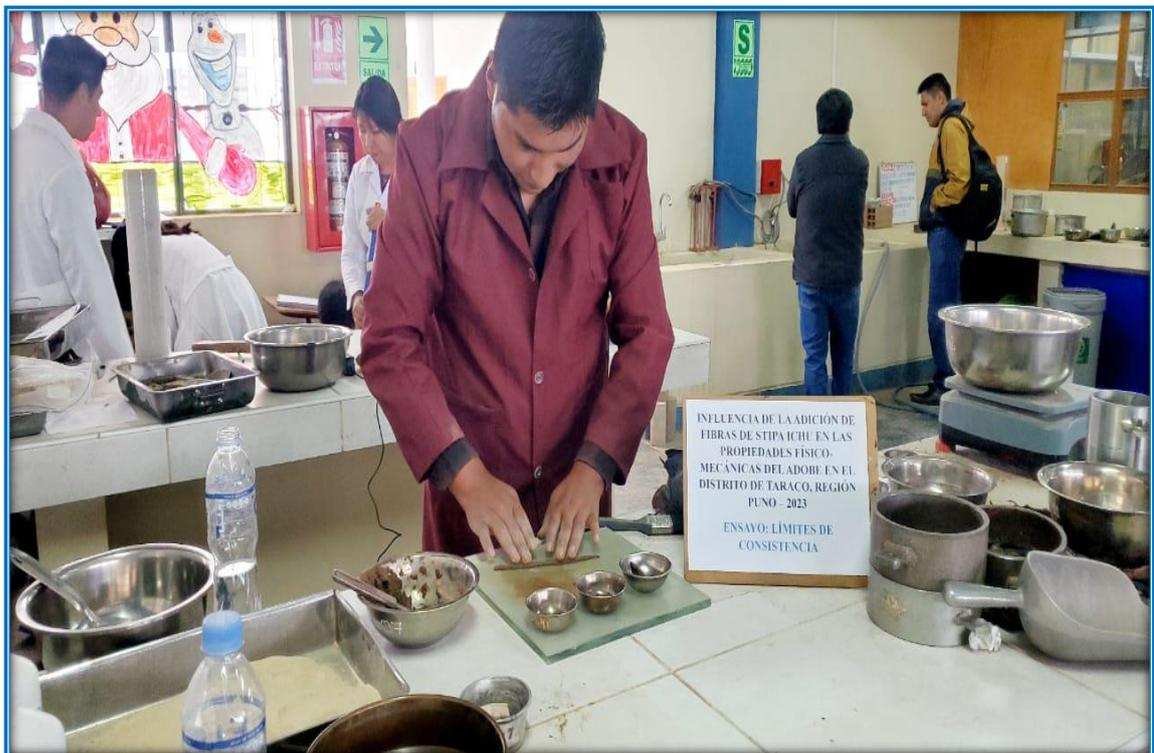
Nota: se visualiza procedimiento para el ensayo de Límite Plástico
