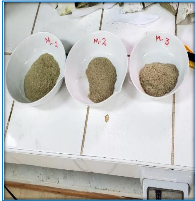
Nota: Se prepara la muestra que se obtiene moliendo las tres muestras después de haber sido secado la muestra a 65°C.
