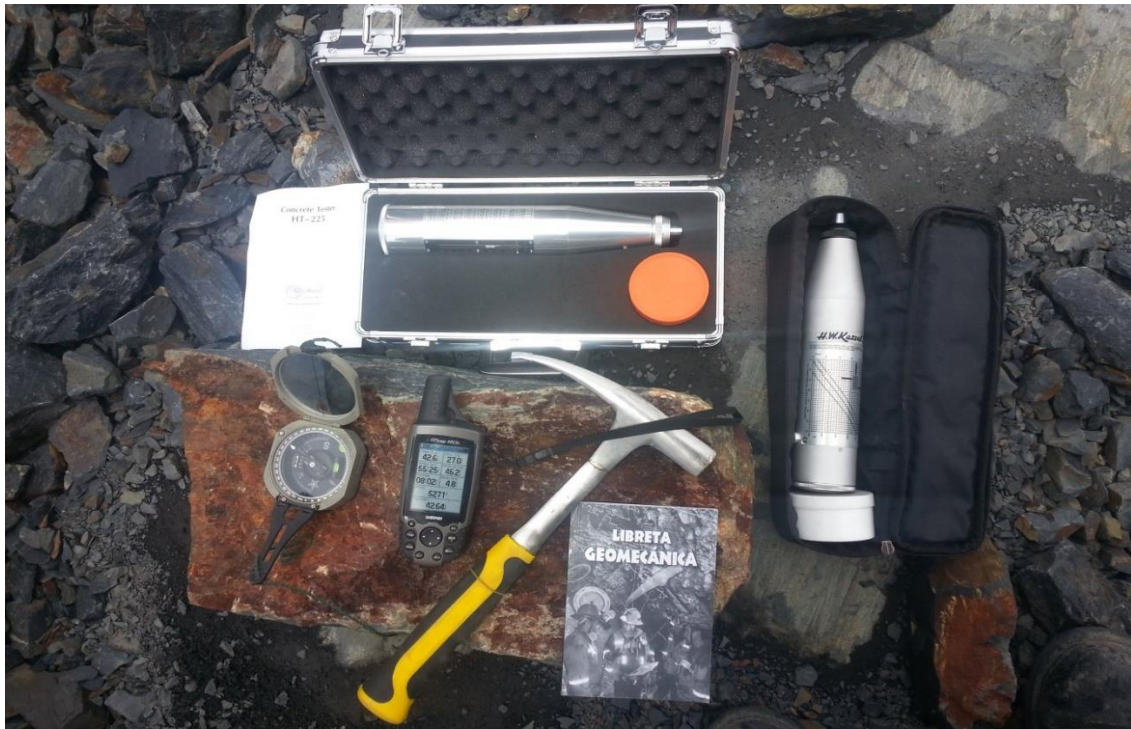
Figura 74. Instrumentos para la toma de datos de geomecanica
