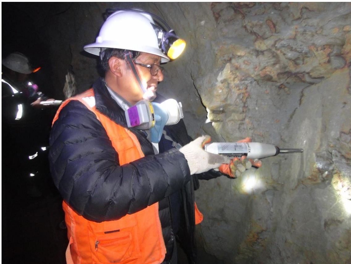
Figura 75. Toma de datos en campo con esclerómetro
