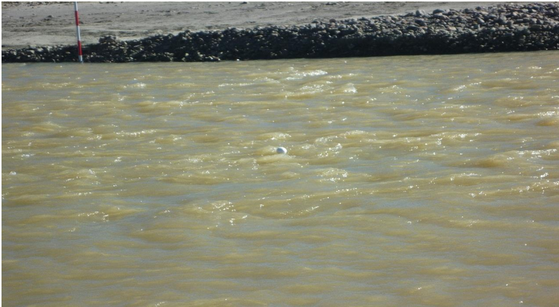
Figura 17. Medición de caudal por el método del Flotador
