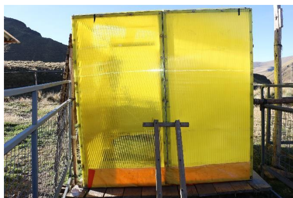
Figura 59. Sellado de la cámara de acumulación de gases.
