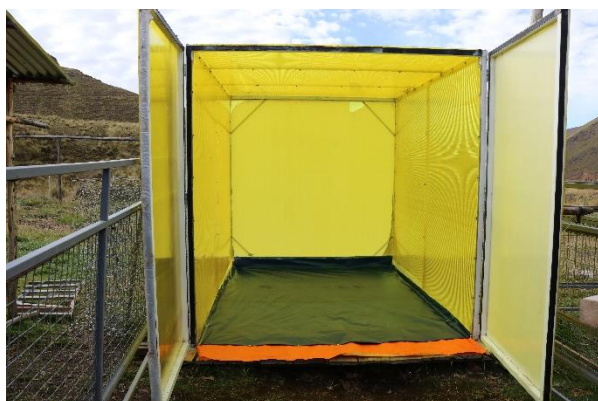
Figura 50. Cámara para acumulación de gases.
