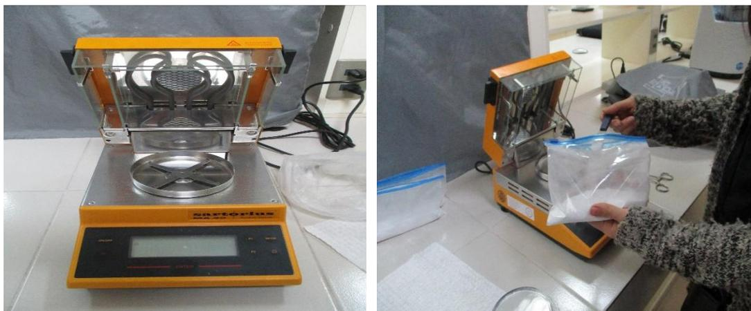
**Figura 6.** Analizador de humedad electrónico – infrarojo MA20
