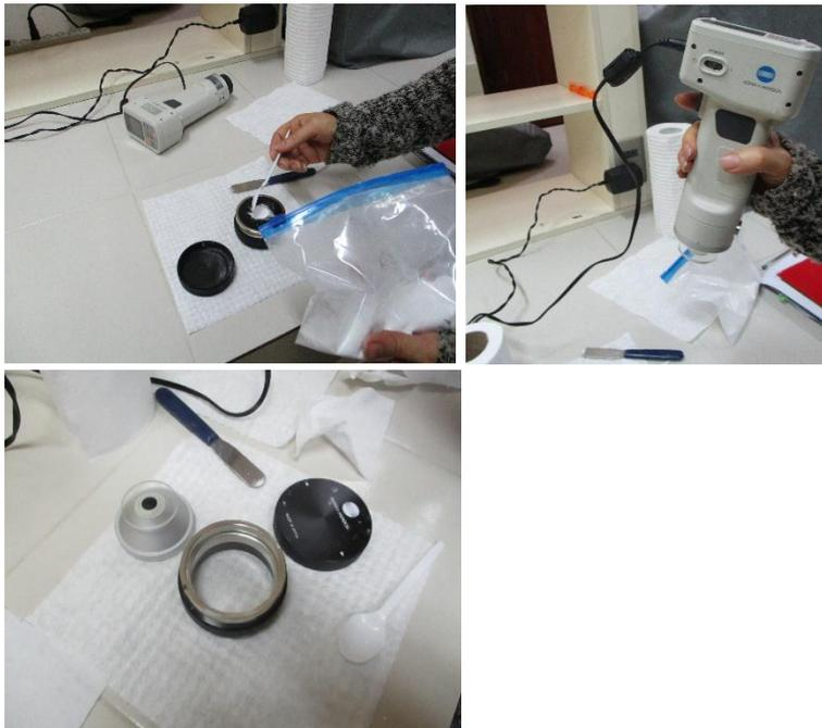
Figura 27. Determinación de color – colorímetro Minolta
