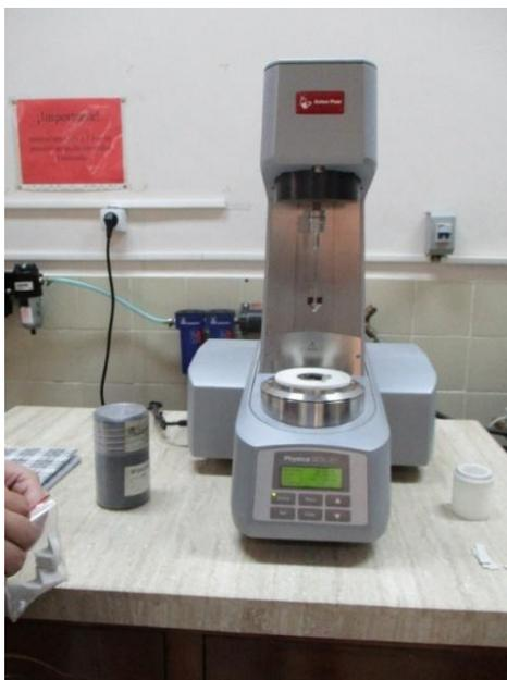
**Figura 8.** Reómetro Physica MCR301
