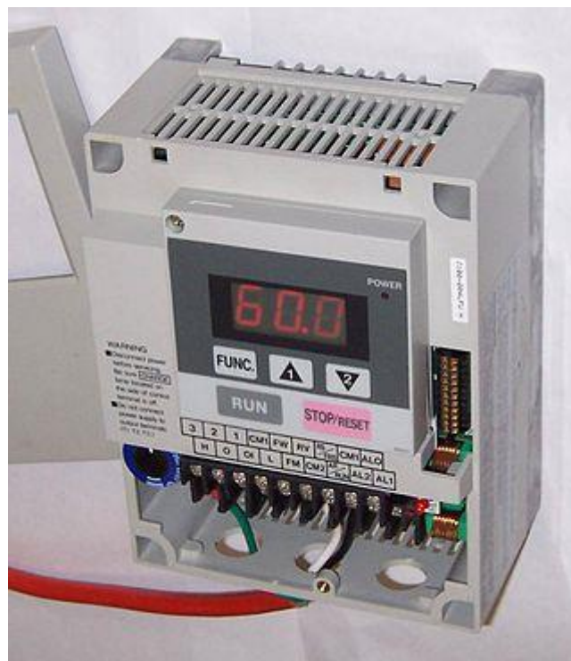
Figura 45 Variador de Frecuencia.
