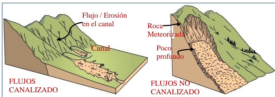
Figura 2 Tipos de flujo de detritos Fuente: Cruden y Varnes (1996).
