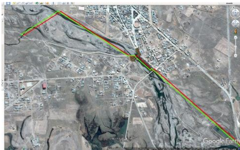
Figura 51: Comparación de las poligonales con puntos topográficos y UTM WGS 84 en Google Earth. Fuente: Elaboración propia
