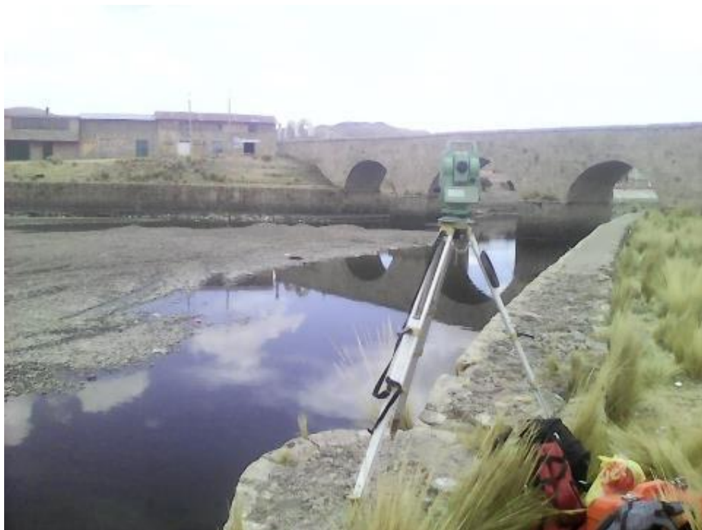
FOTO N° 07: Monumentación y Pintado del Punto de Control Secundario V – L4 en el río Lampa ubicado en el Puente Colonial de Lampa.
