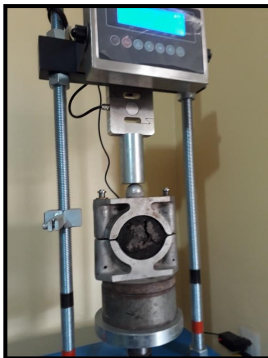
Figura 32. Foto del instante de rotura Marshall.
