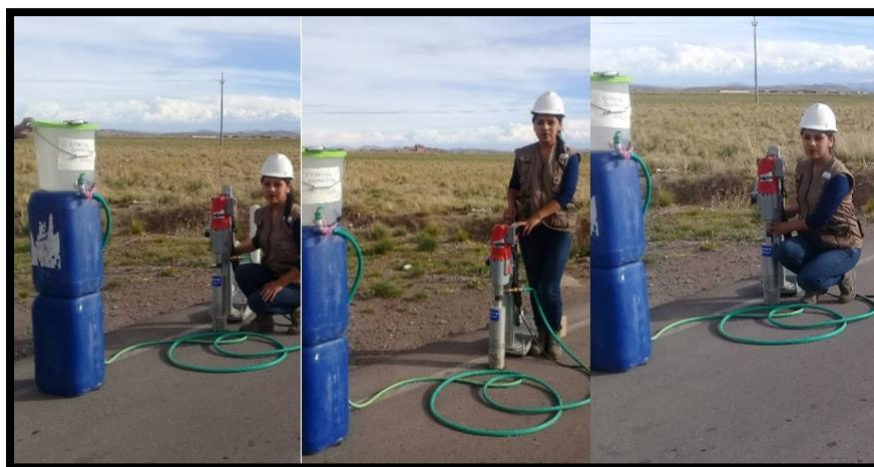
Figura 22. Fotos del instalado de la perforadora diamantina en el Km. 00+020.
