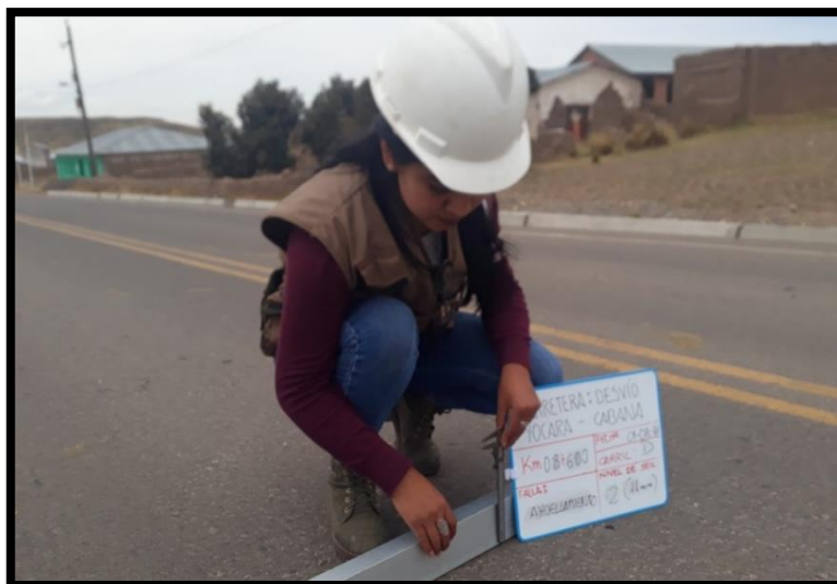
Figura 15. Foto de medición de profundidad de ahuellamiento.
