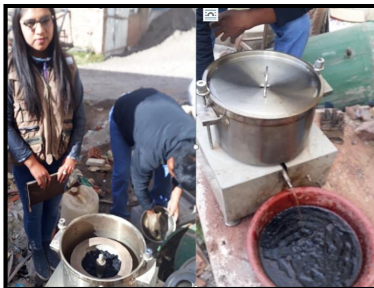
Figura 33. Foto del proceso de lavado asfáltico de muestras.
