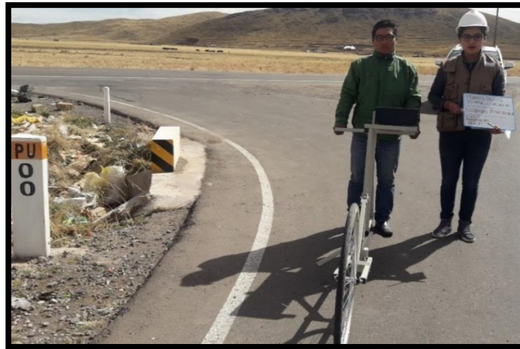
Figura 18. Foto de inicio de medición de rugosidad Km 00+000.
