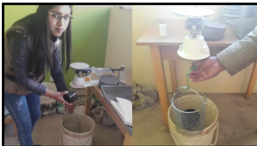
Figura 30. Foto durante de toma de pesos, al aire y al agua, de las muestras diamantina.
