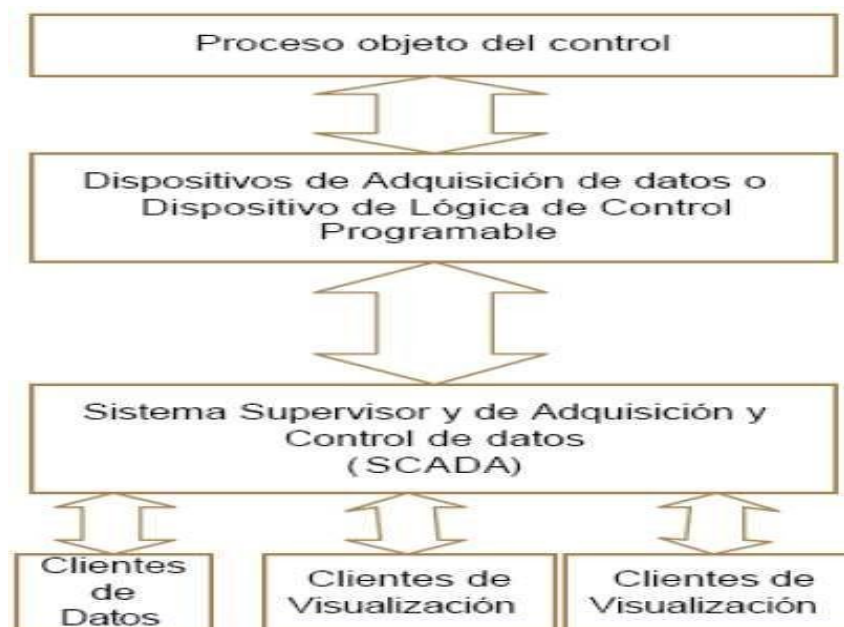
Figura N° 2. 2 Esquema básico de un sistema SCADA
