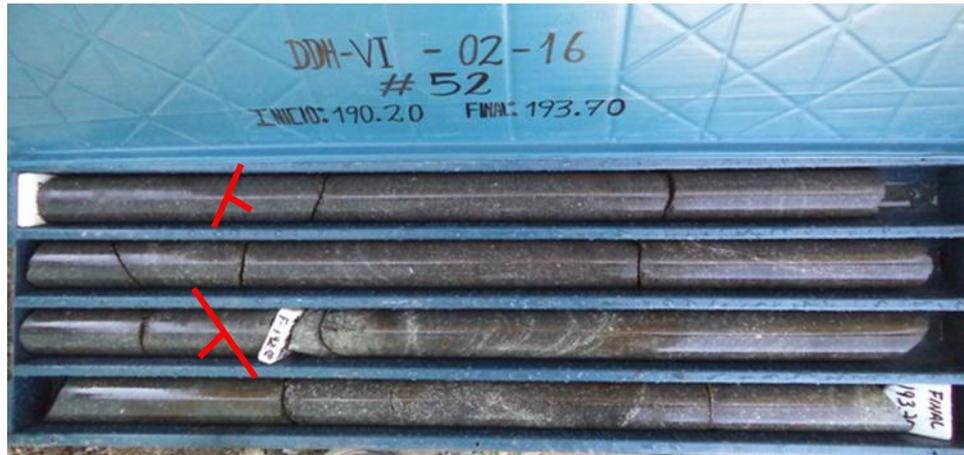
Figura 34. Testigos de perforación diamantina DDH –VI-02-16; se observan dos sistemas de discontinuidades dominantes principales, sin relleno, poco alterado. Roca de muy buena consistente dique de dioritas de textura porfídica.
