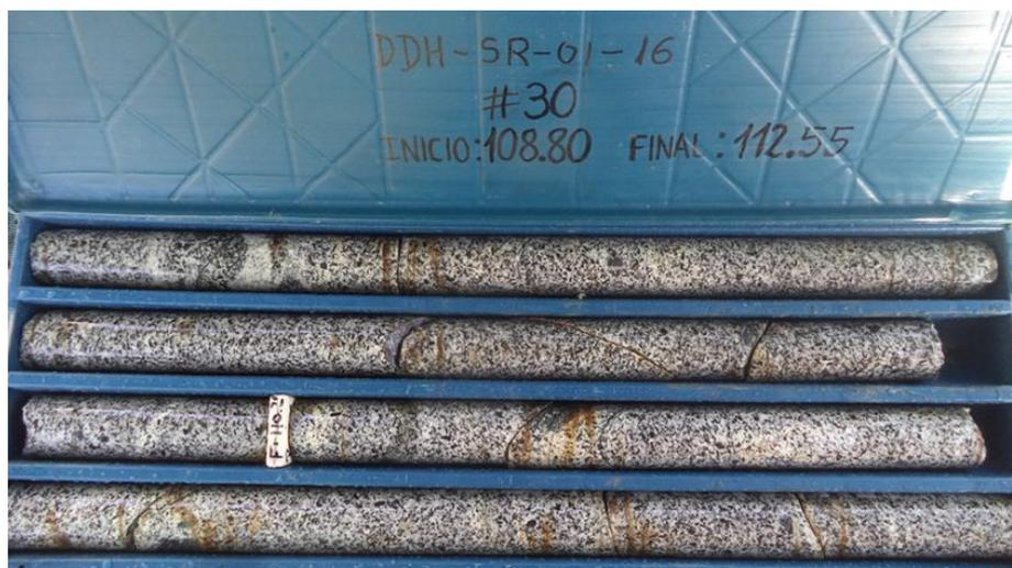
Figura 9. Cores de perforación diamantina, que muestra la recuperación de testigos al 100%.
