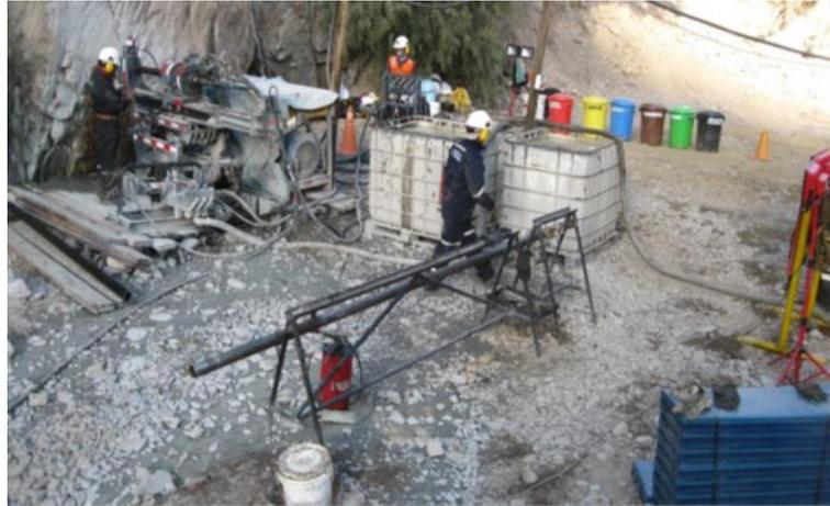
Figura 3. Plataforma de perforación diamantina; se observan equipos y herramientas y accesorios como portamuestra.
