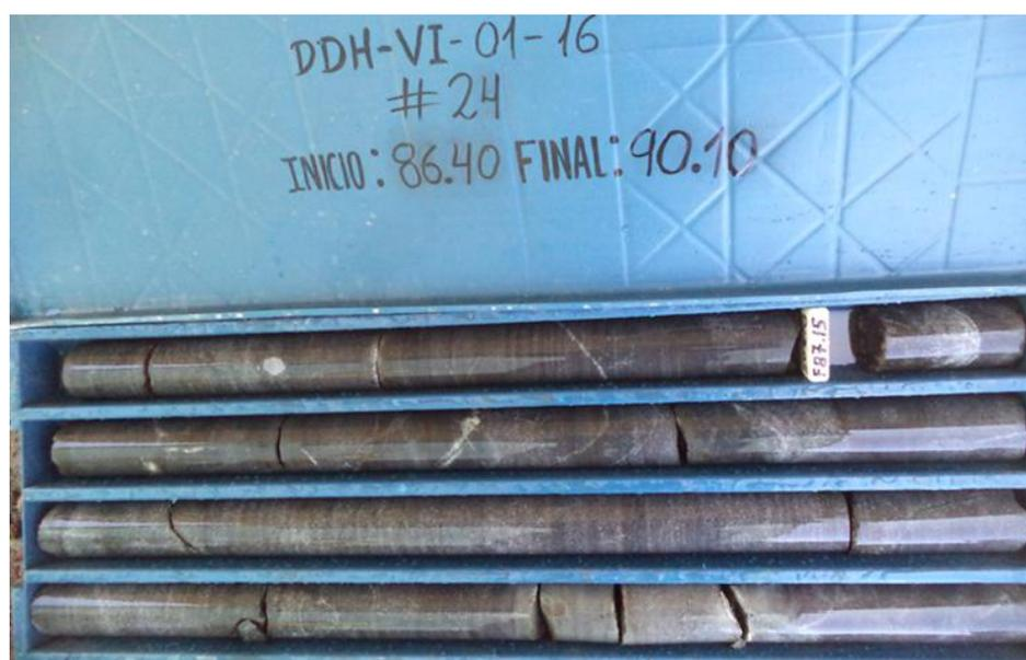
Figura 29. Testigos de perforación diamantina en el sondeo DDH- VI-01-16, que corresponde a una diorita de textura porfídica de fenocristales de plagioclasas, piroxenos, biotitas y minerales de alteración, que se observan entre las juntas.
