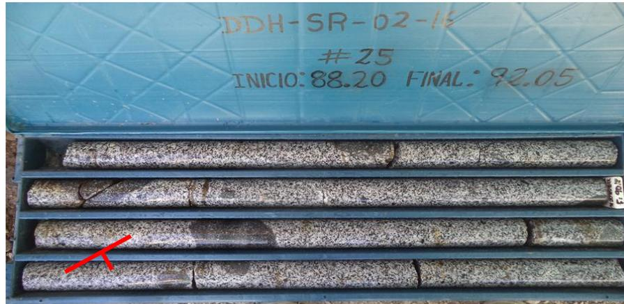
Figura 15. Testigos de perforación diamantina, con una recuperación de 100%; son granodioritas de textura gráfica, con fenocristales de plagioclasas, piroxenos y biotitas; se observa un sistema principal de discontinuidades, de superficie rugosa. Profundidad de 88.20 – 92.05 m, roca de muy buena calidad.
