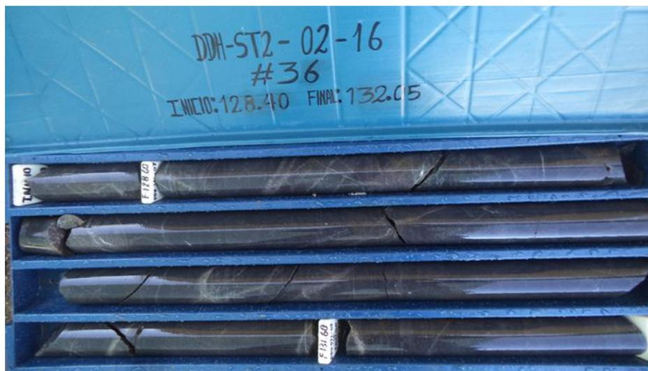
Figura 24. Testigos de perforación diamantina de DDH-ST2-02-16; roca de buena consistencia, constituidas de dioritas de textura máfica; con fenocristales de plagioclasas, hornblendas. Biotitas y cloritas. Profundidad de perforación 128.40 – 132.65 m.
