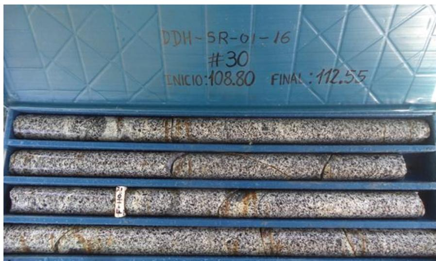
Figura 6. Testigos de perforación diamantina del sondeo DD-SR-01-16, muestra una roca de muy buena calidad, que corresponde a la profundidad de 108 112.55 m con una alteración argílica y propilítica; con dos sistemas de discontinuidades dominantes.
