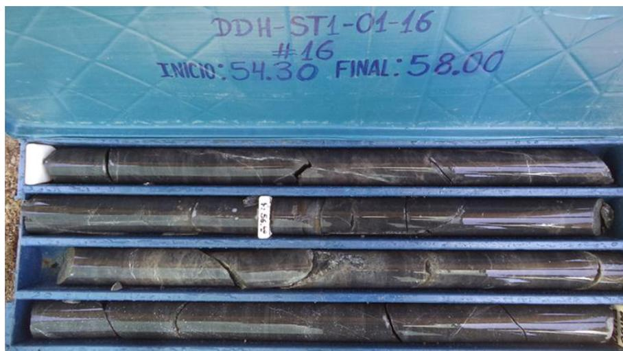
Figura 19. Testigos de perforación diamantina de la profundidad de 54.30 – 58.00; considerados como roca tipo I; intersectadas por dos sistemas de discontinuidades.
