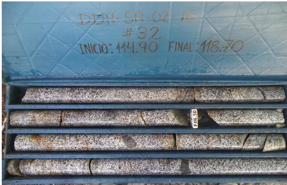
Figura 8. Testigos de perforación diamantina sobre la estructura mineralizada de la veta Esperanza, que corresponde una roca de nueva calidad en la profundidad de 115 – 118.70 m de profundidad con un sistema de discontinuidades dominantes.
