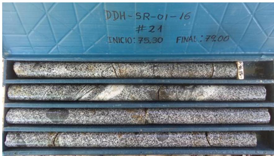
Figura 5. El grado de alteración en esta corrida, es mínima, entre los planos de sistemas de discontinuidades, solo se observan sericitas y rocas triturada. La roca es sana, que corresponde a la profundidad de 75.30 – 79.00 m.
