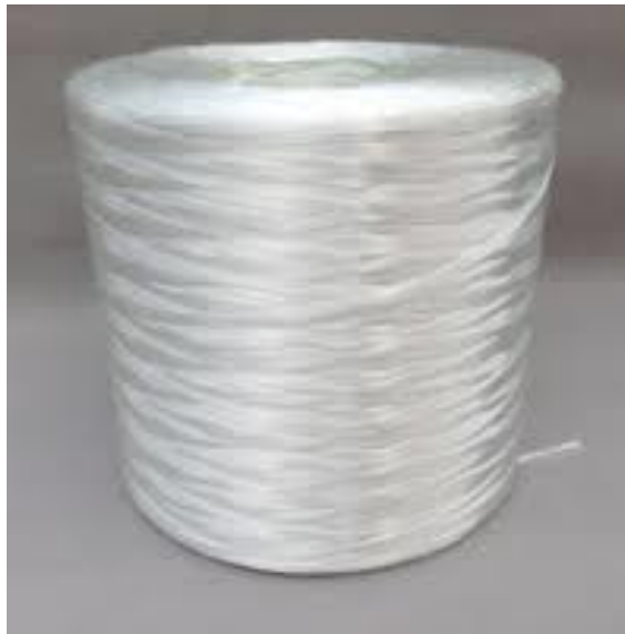
Figura N° 2.4: Presentación en bobina de fibra de vidrio
