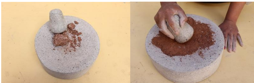
Figura 3. Triturando la arcilla en el mortero.
