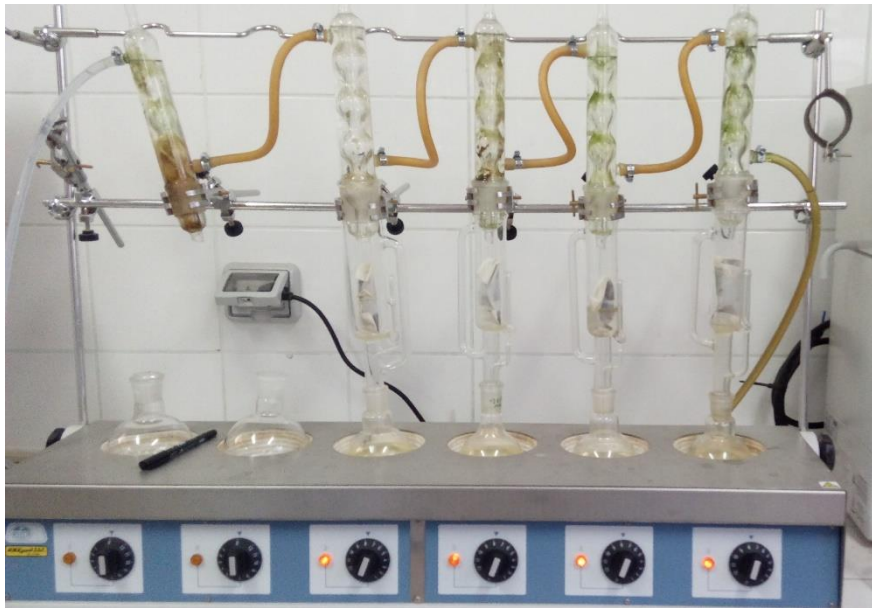
Fotografía N° 6 Método Soxhlet y concentración del extracto lipídico de la quinua negra.
