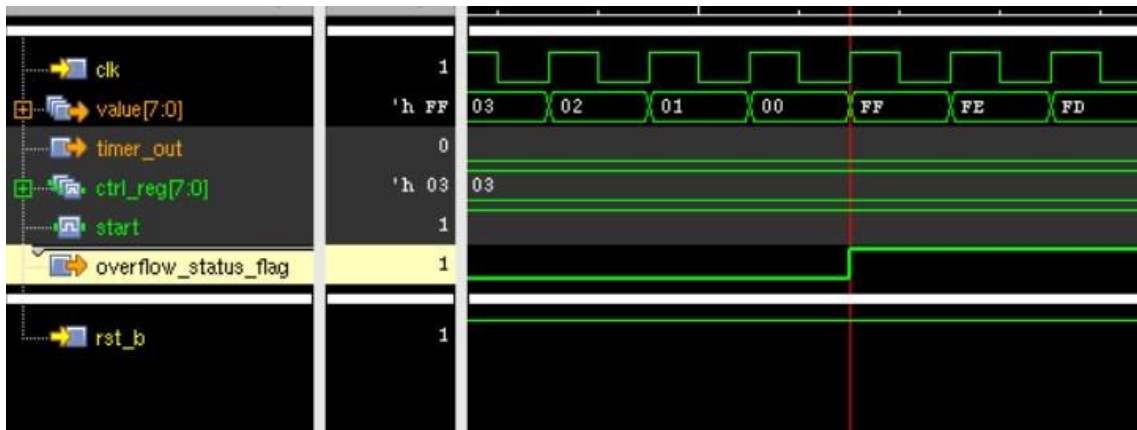
Figura 4.7 Ejecución libre, desbordamiento modo de cuenta descendente.
