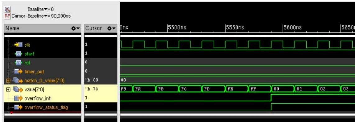
Figura 4.19 Interrupción por desbordamiento.
