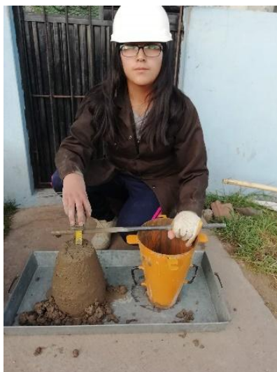
Figura 11: Ensayo de asentamiento en el cono de Abrams
