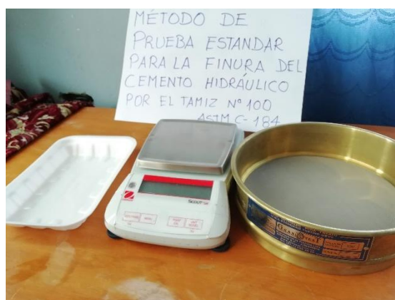
Figura 10: Método de prueba estándar para la finura del cemento hidráulico por el tamiz N°100
