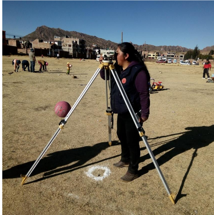
FIGURA N° 21: Nivelación geométrica con nivel automático NIKON AC - 2S
