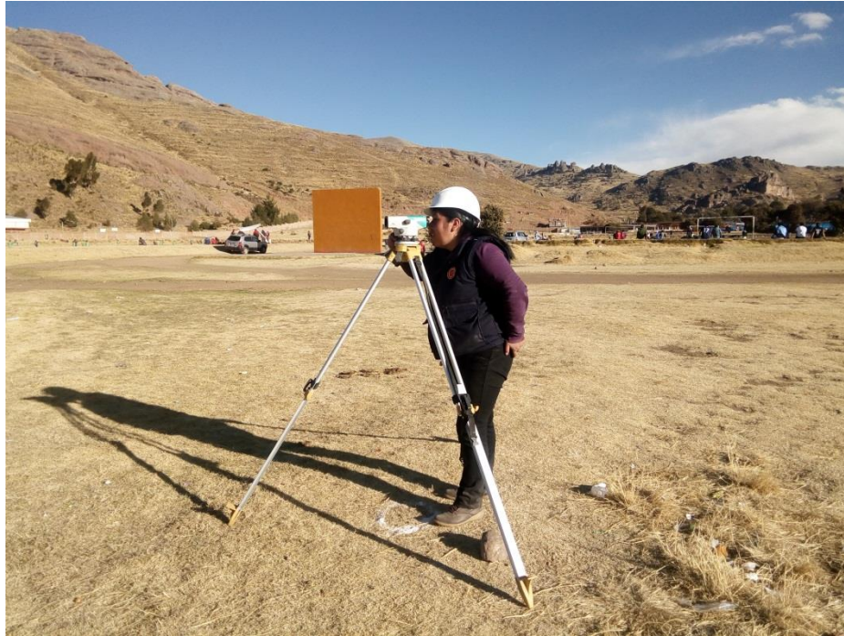
FIGURA N° 23: Nivelación geométrica con nivel automático SOKIA B40
