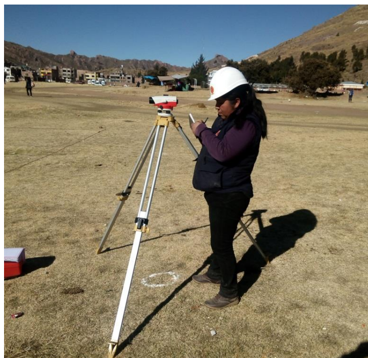
FIGURA N° 20: Nivelación geométrica con nivel automático LEICA NA720
