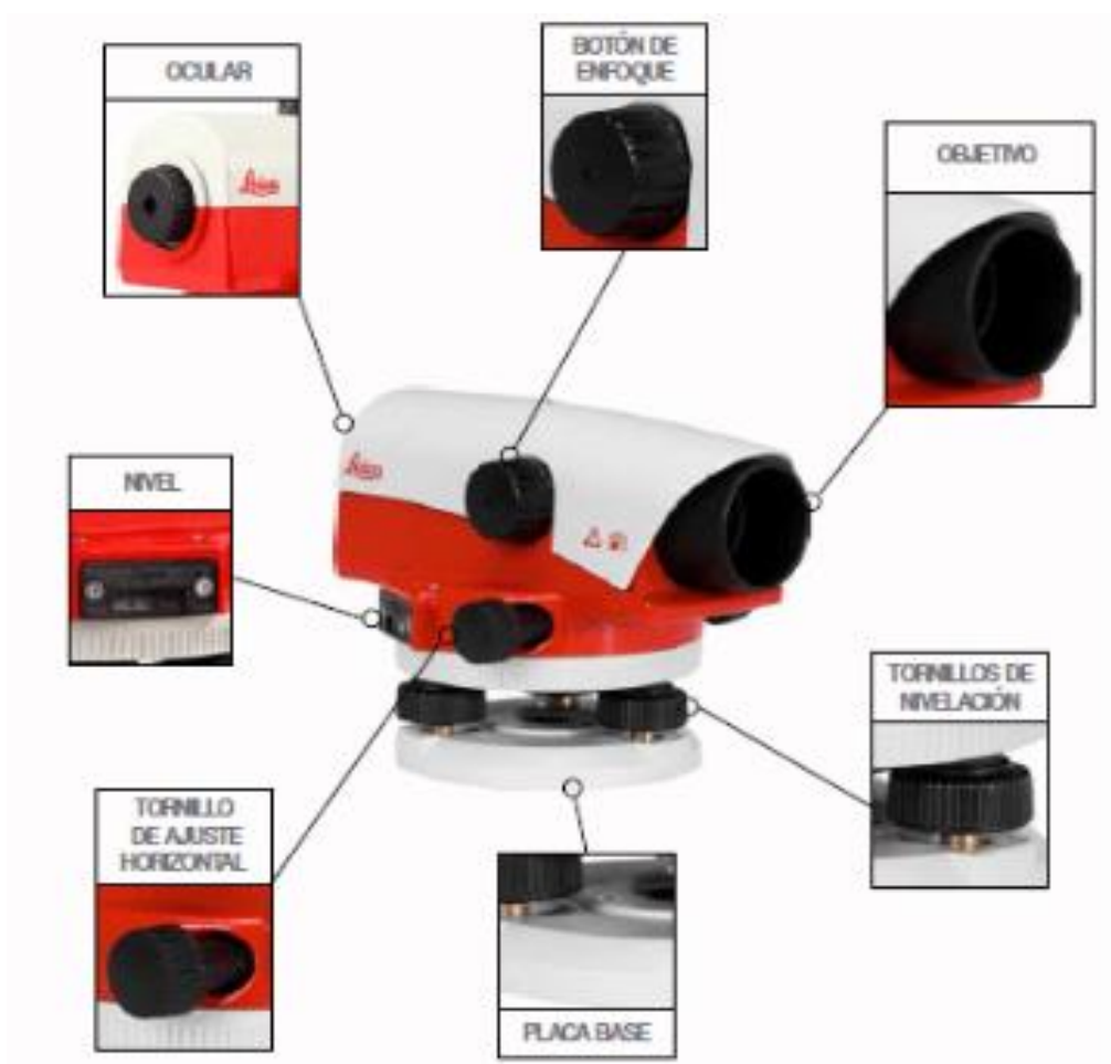
FIGURA N° 15: Partes de un nivel de Ingeniero Fuente: Geotop
