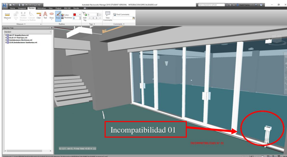
Figura N° 49: Incompatibilidad N° 01: Mampara (Arquitectura) conflicto con Tomacorriente (I. Eléctricas) FUENTE: Elaboración propia
