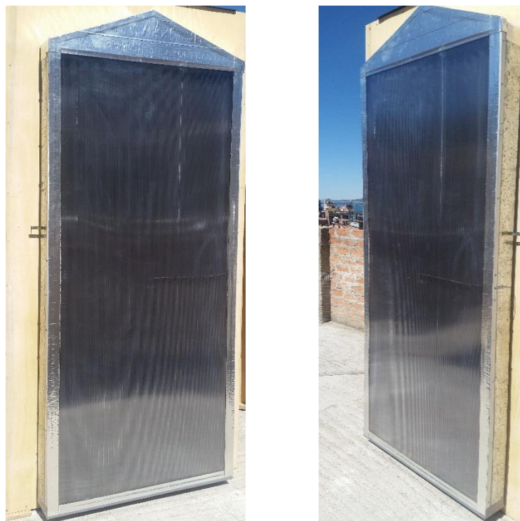
Figura 10. CSCA de doble flujo en paralelo que opera por flotación natural instalado verticalmente vista desde dos ángulos distintos.
