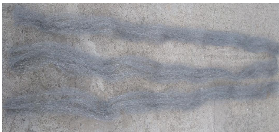
Figura 11. Virutilla de acero utilizado como empaque poroso en el canal 2 de CSCA.
